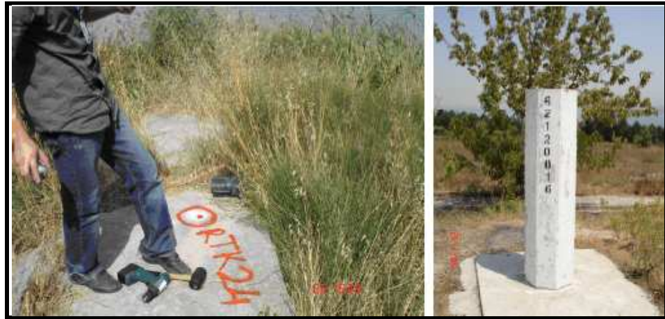
Şekil 3.15: Ölçümlerde kullanılan yer noktasına ve pilyeye ait örnek görüntü (TÜBİTAK-MAM, 2008).
