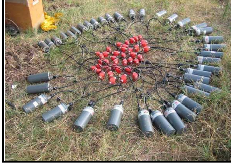
Şekil 3.7: Sismik Kırılma etütlerinde kullanılan kayıtçı ve jeofon sistemi(TÜBİTAK-MAM, 2008).
