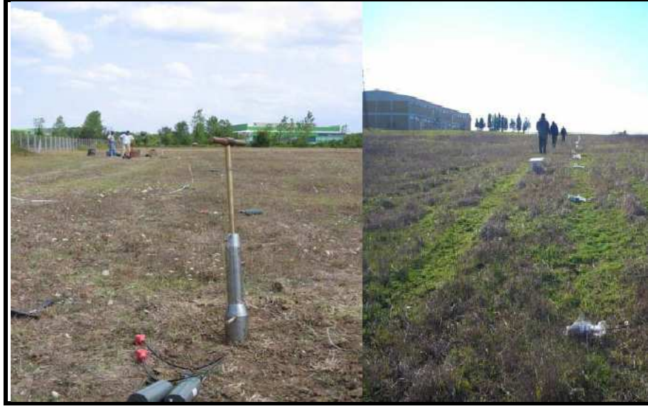
Şekil 3.8: Sismik Kırılma etütlerinde kullanılan sismik enerji kaynağı, Buffalo Gun ve yerleştirilen cihazların bir görüntüsü(TÜBİTAK-MAM, 2008).
