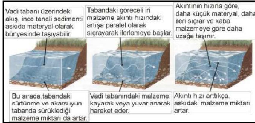
Şekil 3.44: Bir akarsu içerisindeki sediment yükü ve hareket mekanizması (Press vd., 2004'den Yıldırım ve Gökaşan 2007 tarafından değiştirilerek).
