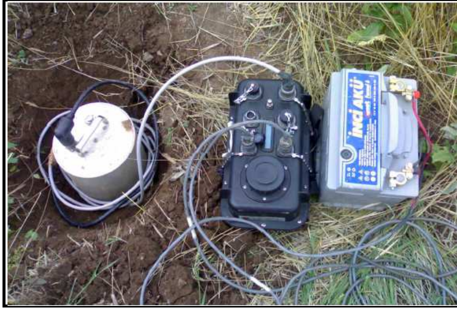
Şekil 3.2: Reftek 130 (siyah renkli) ve L4-3C sismometre kayıtçı sistemi(TÜBİTAK-MAM, 2008).
