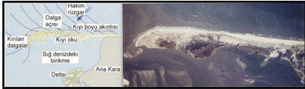
Şekil 3.59: Kıyıya açılı gelen dalga ile sürüklenen ince kırıntılı sedimentlerin, sahil çizgisi geriye büküldüğü yerlerde oluşturduğu kıyı oku (Hamblin ve Cristiansen, 2004'den Yıldırım ve Gökaşan 2007 tarafından değiştirilerek).
