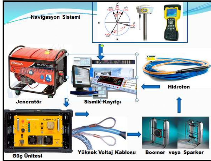
Şekil 3.19: Yüksek Rezolüsyonlu Sparker-Boomer Sığ Sismik Sistemi
