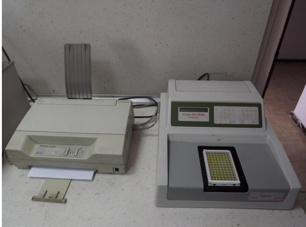
Şekil 2.2. ELISA Reader (okuyucu) cihazı.
