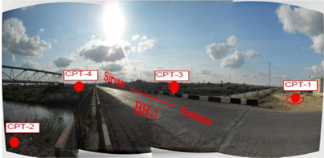
Şekil 3.18. H1 köprüsü (km 6+544) CPT test planı
