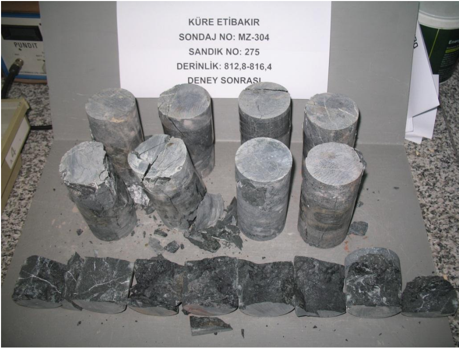
Şekil A.22: Mz-304 sandık no:275 tek eksenli basınç ve çekme deneyi sonrası.
