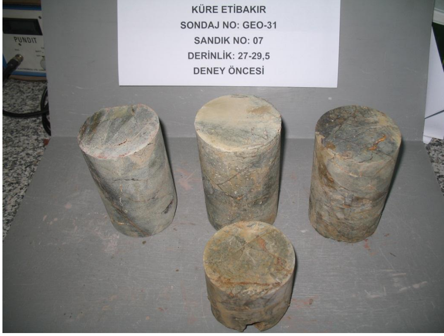
Şekil A.13: Geo-31 tek eksenli basınç ve çekme deneyi öncesi.
