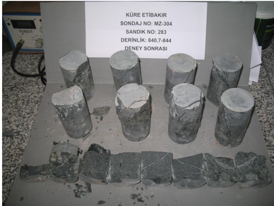
Şekil A.24: Mz-304 sandık no:283 tek eksenli basınç ve çekme deneyi sonrası.
