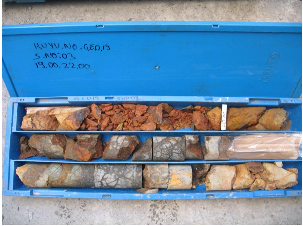
Şekil B.3: Geo-19 tek eksenli ve çekme basıncı deneyi için alınan karot.
