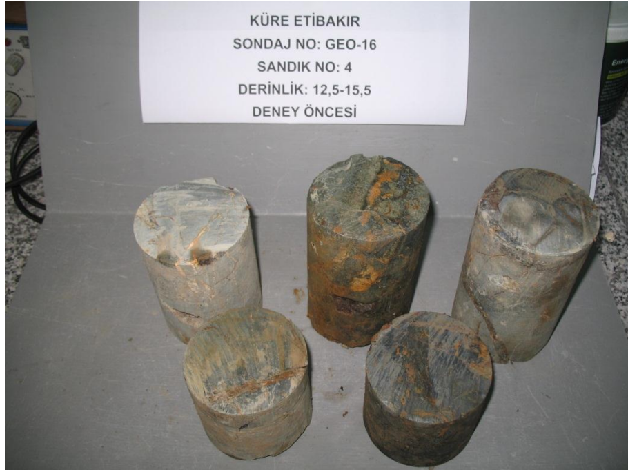
Şekil A.3: Geo-16 tek eksenli basınç ve çekme deneyi öncesi.
