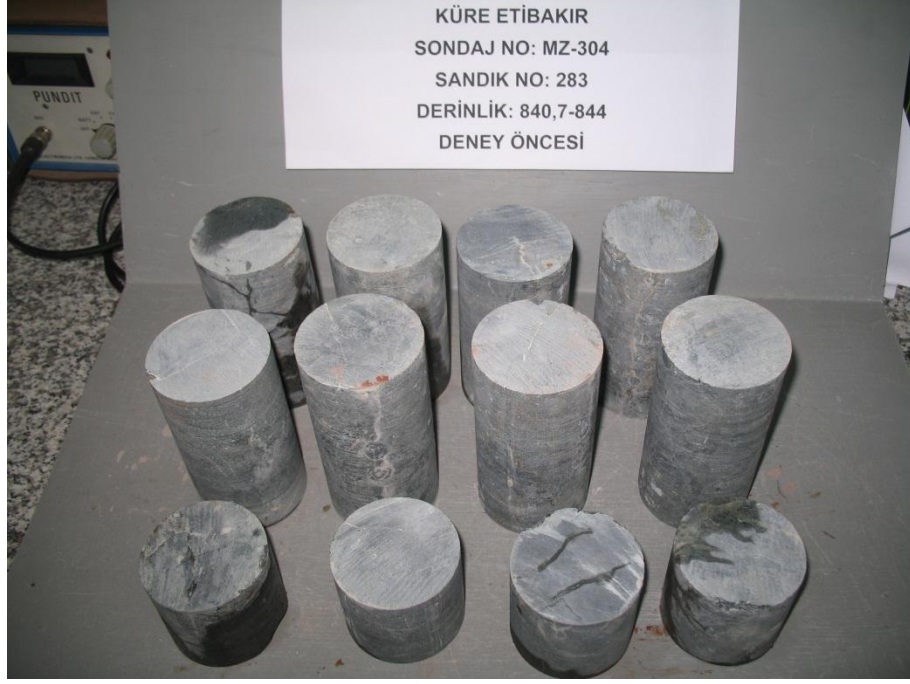
Şekil A.23: Mz-304 sandık no:283 tek eksenli basınç ve çekme deneyi öncesi.
