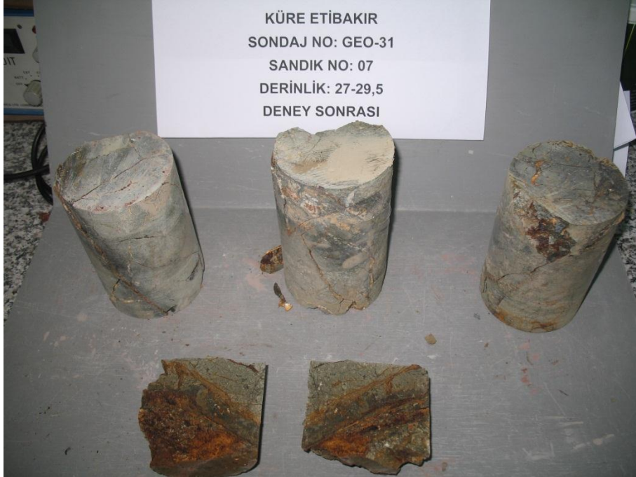
Şekil A.14: Geo-31 tek eksenli basınç ve çekme deneyi sonrası.
