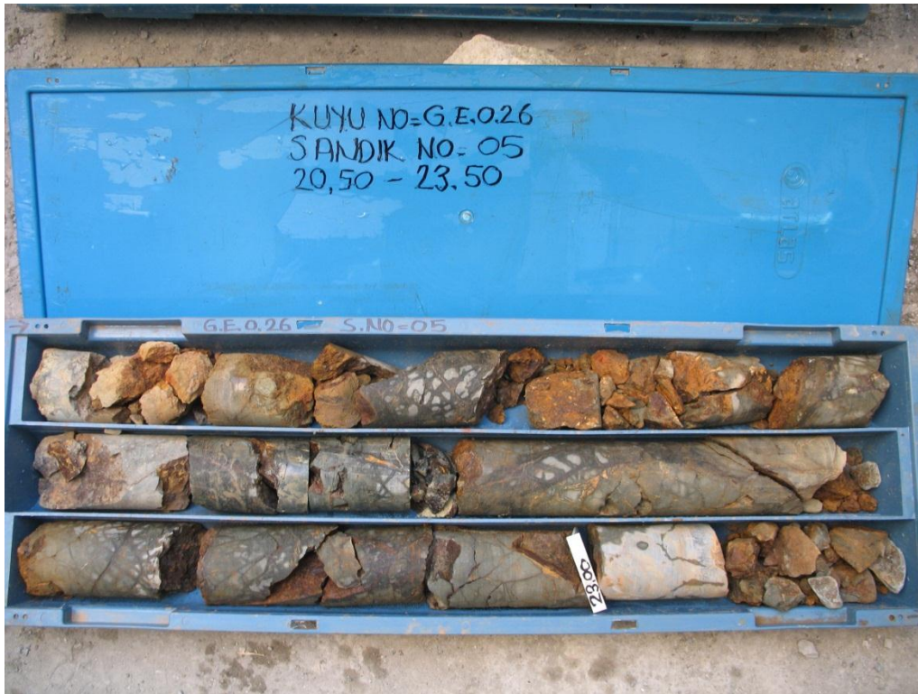
Şekil B.6: Geo-26 tek eksenli ve çekme basıncı deneyi için alınan karot.
