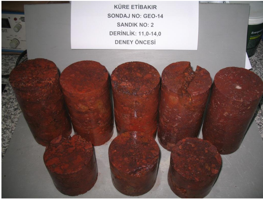
Şekil A.1: Geo-14 tek eksenli basınç ve çekme deneyi öncesi.
