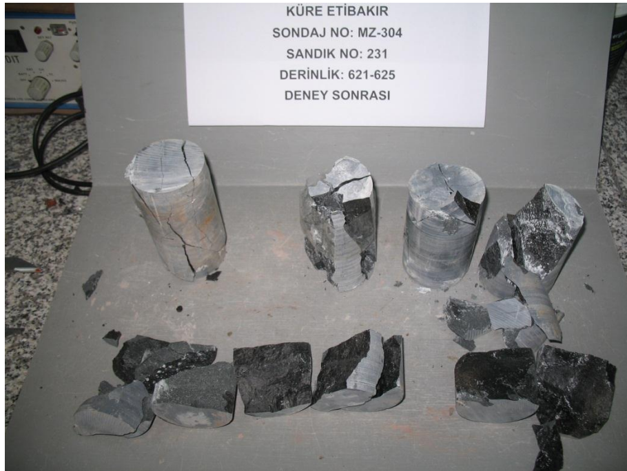
Şekil A.20: Mz-304 sandık no:231 tek eksenli basınç ve çekme deneyi sonrası.
