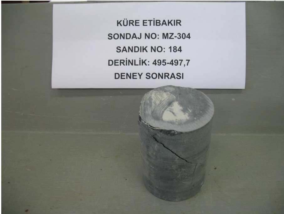
Şekil A.18: Mz-304 sandık no:184 tek eksenli basınç ve çekme deneyi sonrası.
