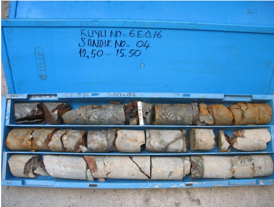
Şekil B.2: Geo-16 tek eksenli ve çekme basıncı deneyi için alınan karot.
