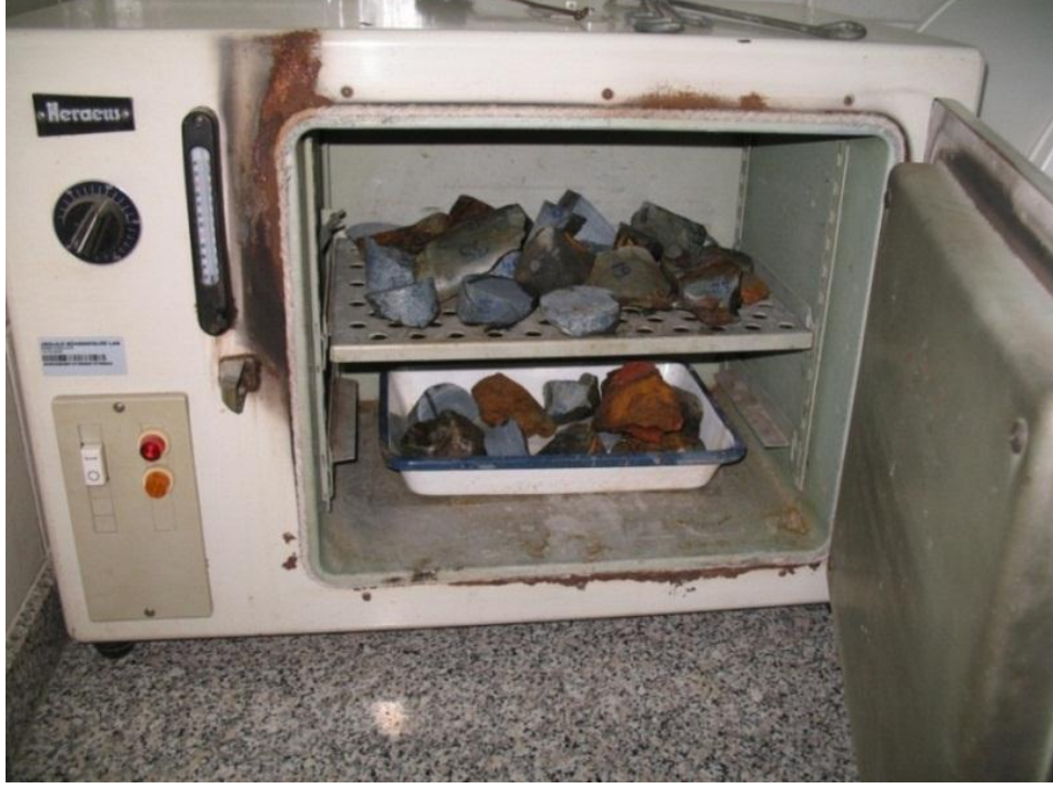
Şekil 5.3: Fiziksel parametreleri belirlemek için etüve yerleştirilen örnekler.
