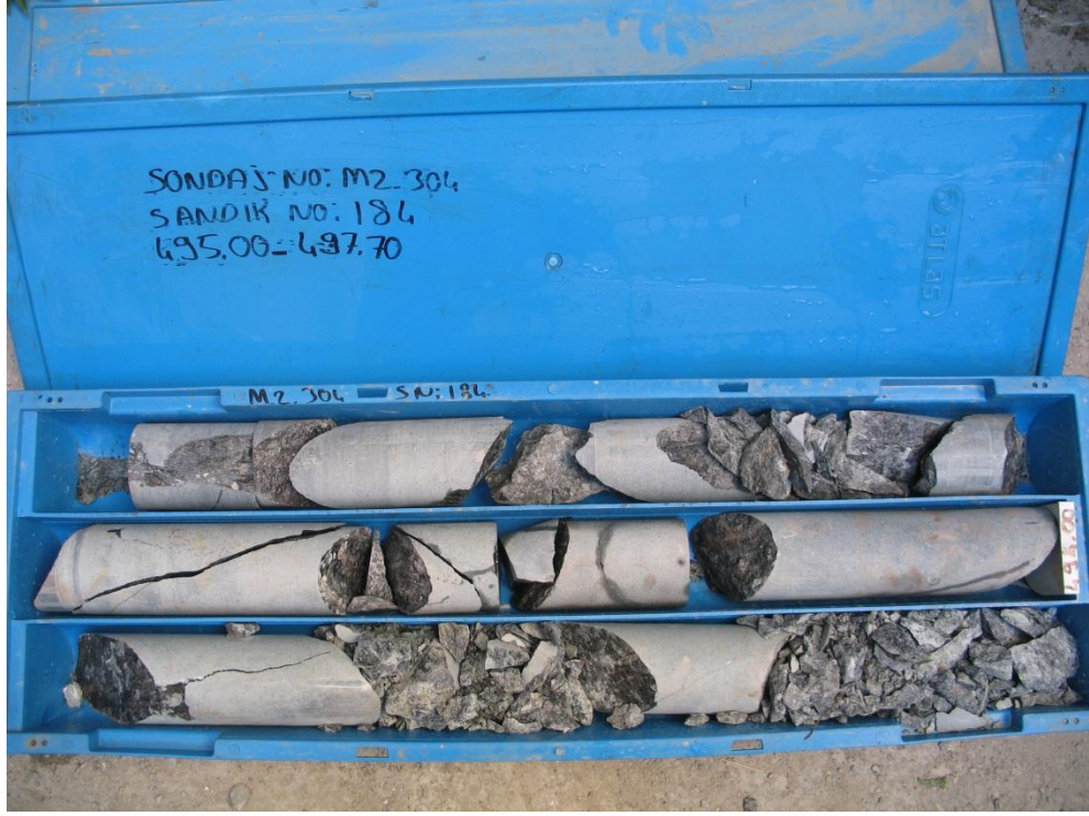
Şekil B.11: Mz-304 S.No. 184 tek eksenli ve çekme deneyi için alınan karot.
