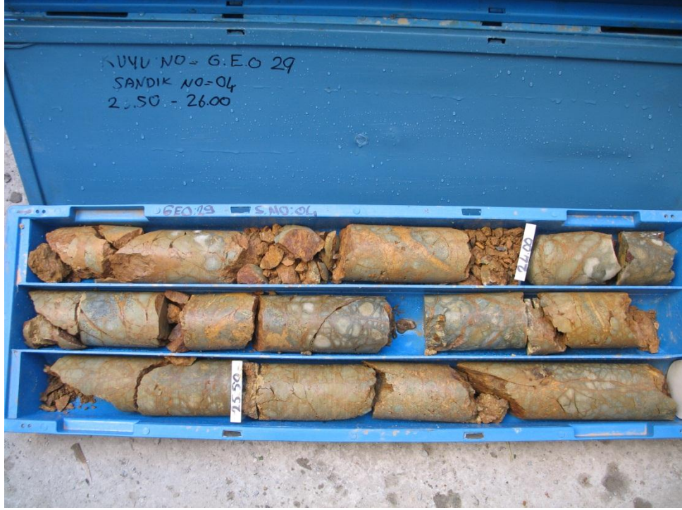
Şekil B.7: Geo-29 tek eksenli ve çekme basıncı deneyi için alınan karot.
