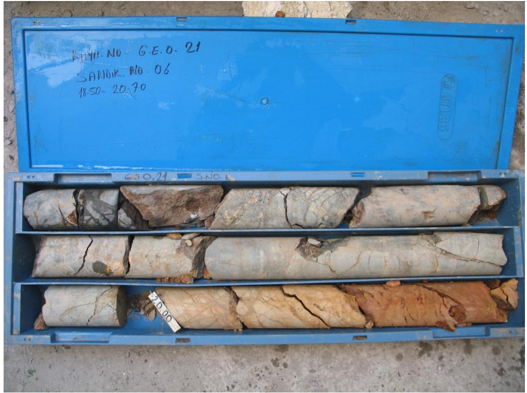
Şekil B.4: Geo-21 tek eksenli ve çekme basıncı deneyi için alınan karot.
