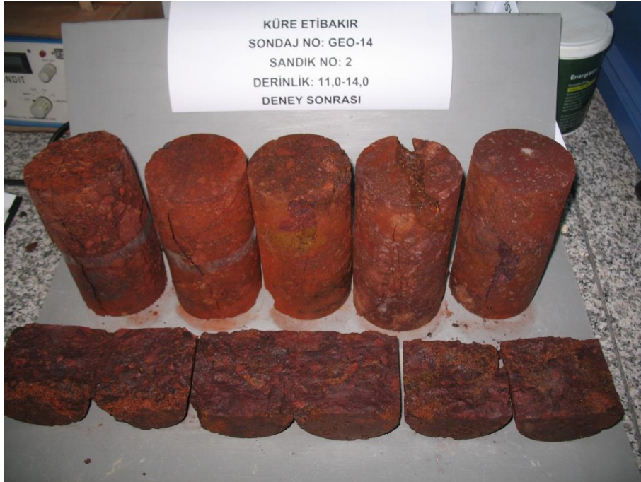
Şekil A.2: Geo-14 tek eksenli basınç ve çekme deneyi sonrası.
