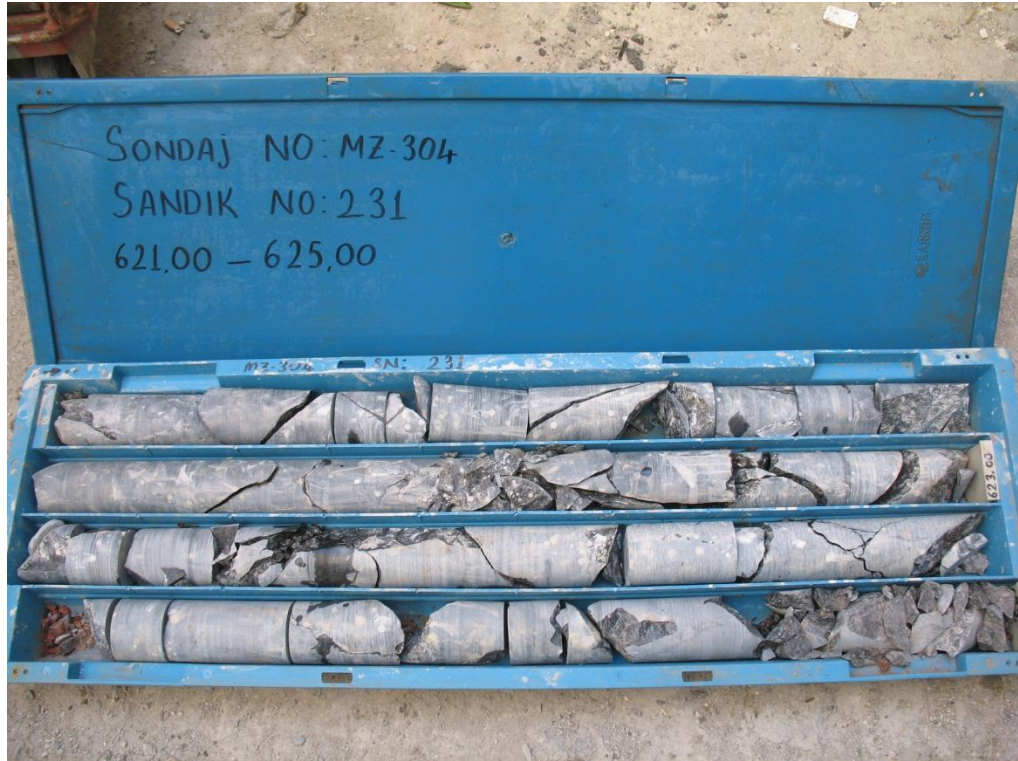
Şekil B.12: Mz-304 S.No. 231 tek eksenli ve çekme deneyi için alınan karot.
