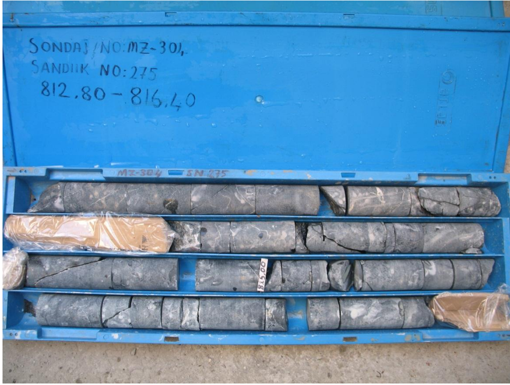
Şekil B.13: Mz-304 S.No. 275 tek eksenli ve çekme deneyi için alınan karot.
