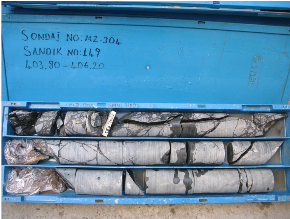
Şekil B.10: Mz-304 S.No. 149 tek eksenli ve çekme deneyi için alınan karot.
