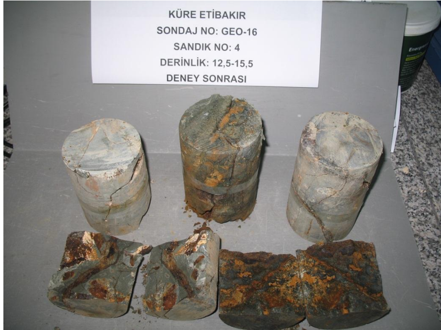
Şekil A.4: Geo-16 tek eksenli basınç ve çekme deneyi sonrası.
