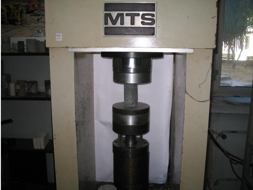
Şekil 5.7: TB-16 numaralı örneğin Deney sırası tek eksenli deneyi.
