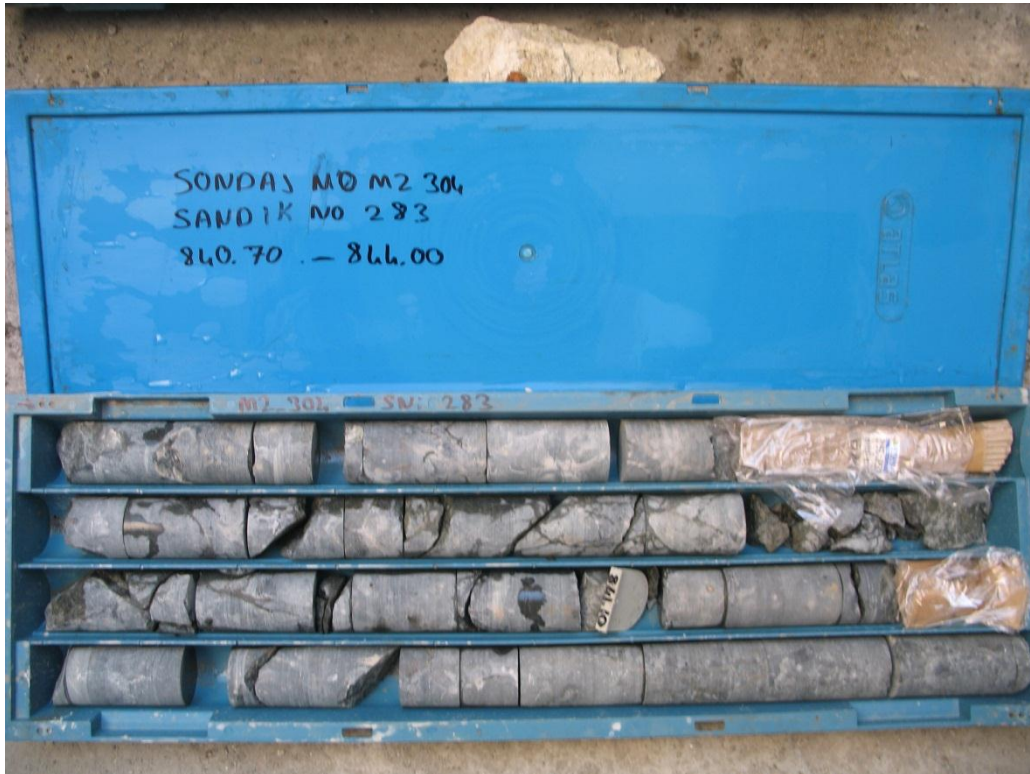
Şekil B.13: Mz-304 S.No. 275 tek eksenli ve çekme deneyi için alınan karot.
