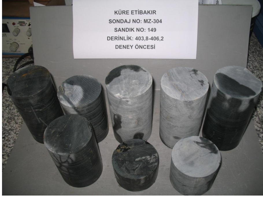
Şekil A.15: Mz-304 sandık no:149 tek eksenli basınç ve çekme deneyi öncesi.
