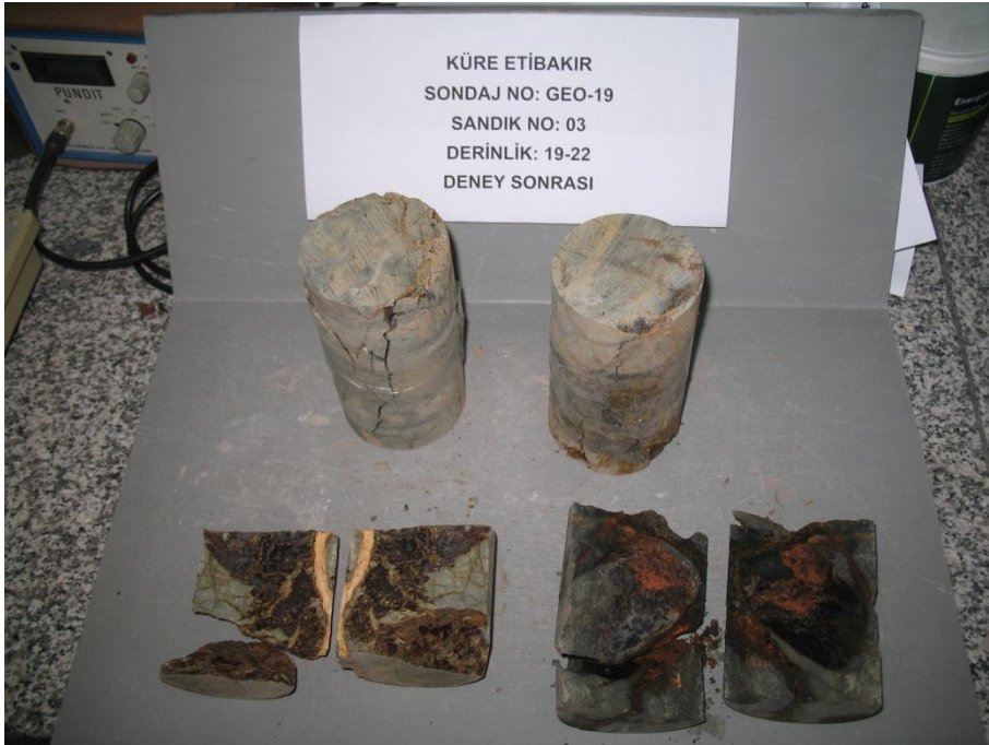
Şekil A.6: Geo-19 tek eksenli basınç ve çekme deneyi sonrası.
