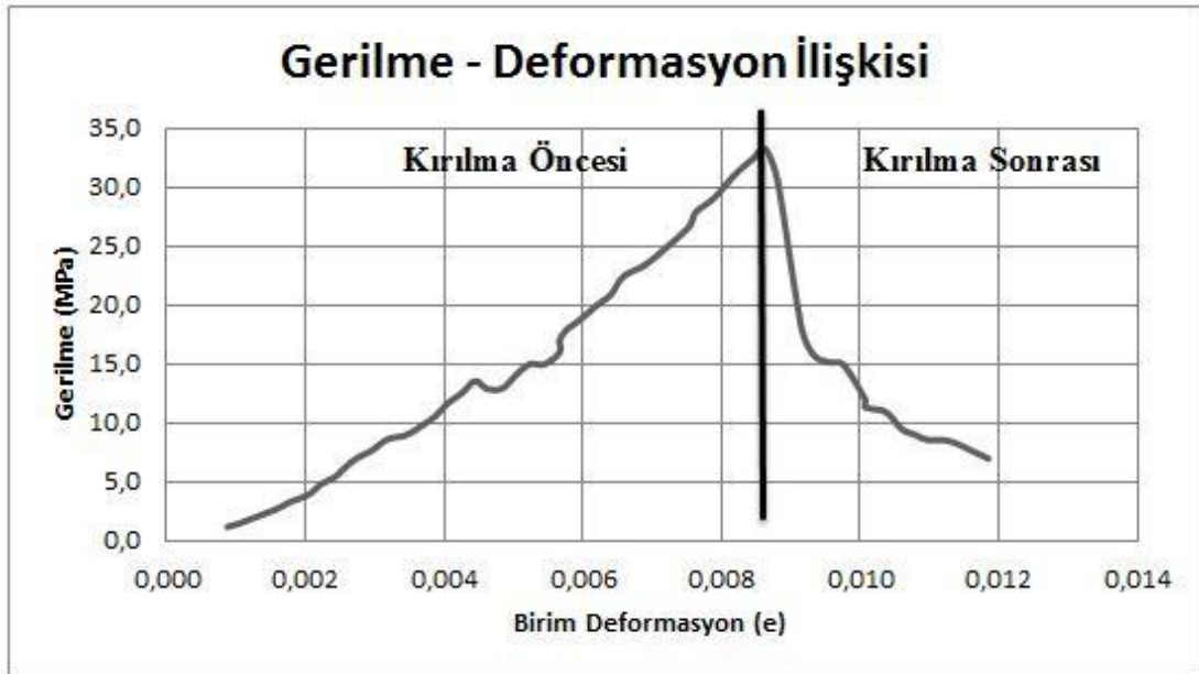
Şekil 5.5: TB-16 numaralı örneğin Gerilme- Birim Deformasyon eğrisi.
