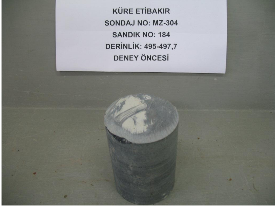
Şekil A.17: Mz-304 sandık no:184 tek eksenli basınç ve çekme deneyi öncesi.
