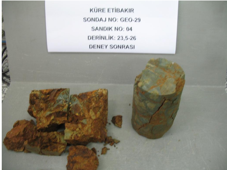
Şekil A.12: Geo-29 tek eksenli basınç ve çekme deneyi sonrası.
