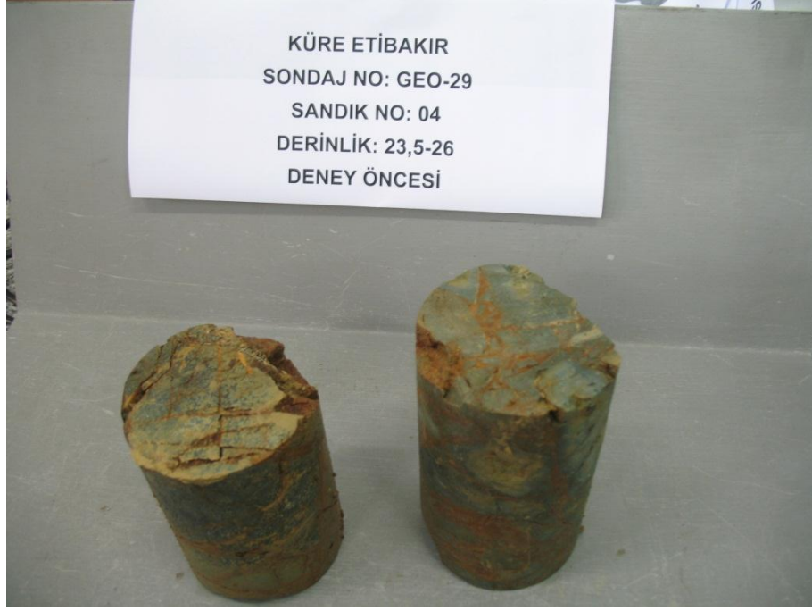
Şekil A.11: Geo-29 tek eksenli basınç ve çekme deneyi öncesi.
