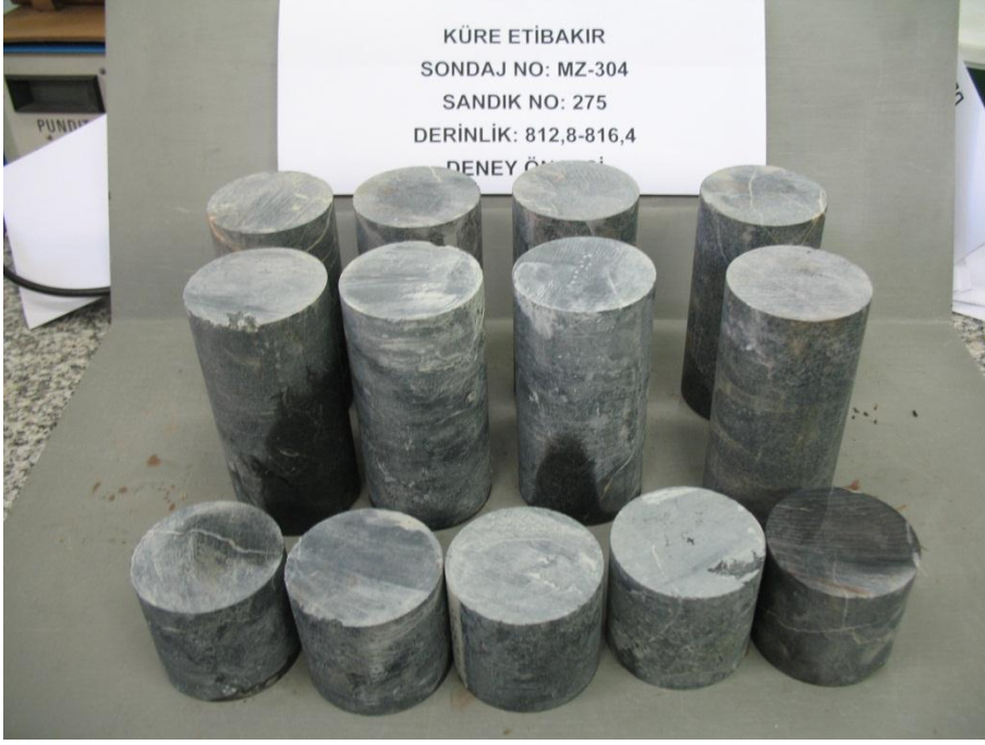
Şekil A.21: Mz-304 sandık no:275 tek eksenli basınç ve çekme deneyi öncesi.
