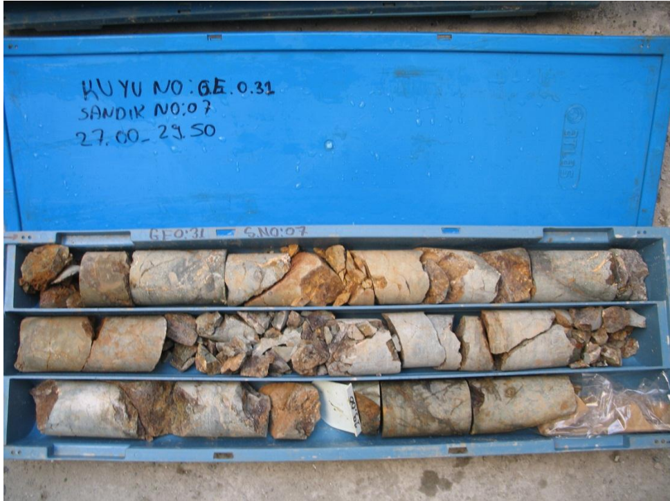
Şekil B.8: Geo-31 tek eksenli ve çekme basıncı deneyi için alınan karot.
