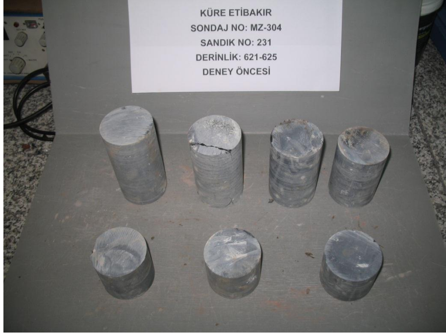
Şekil A.19: Mz-304 sandık no:231 tek eksenli basınç ve çekme deneyi öncesi.
