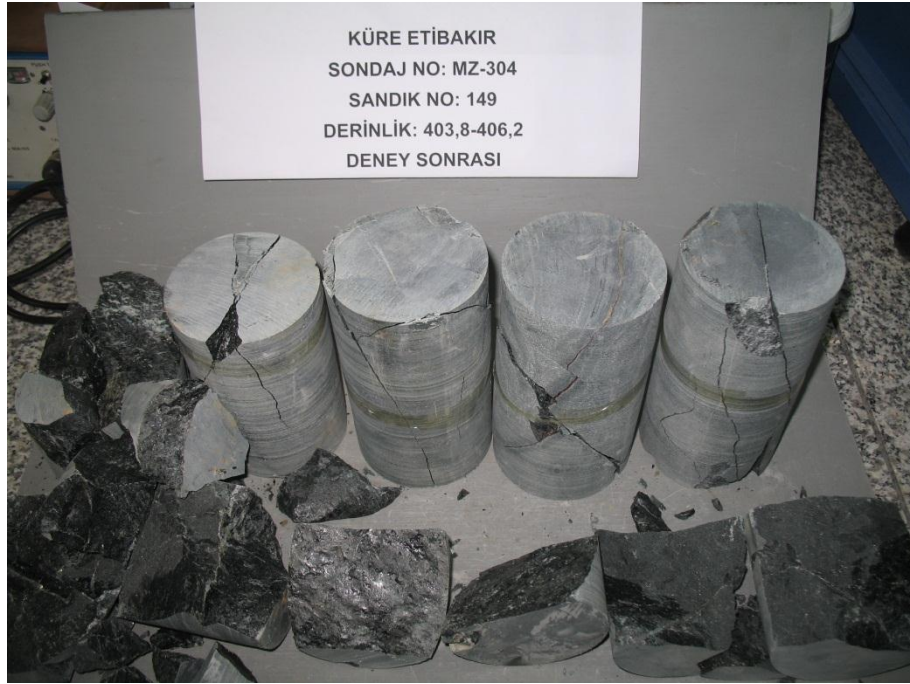
Şekil A.16: Mz-304 sandık no:149 tek eksenli basınç ve çekme deneyi sonrası.
