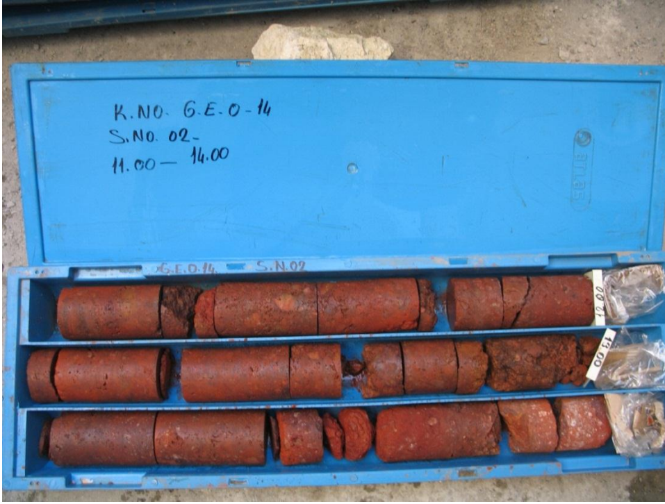
Şekil B.1: Geo-14 tek eksenli ve çekme basıncı deneyi için alınan karot.
