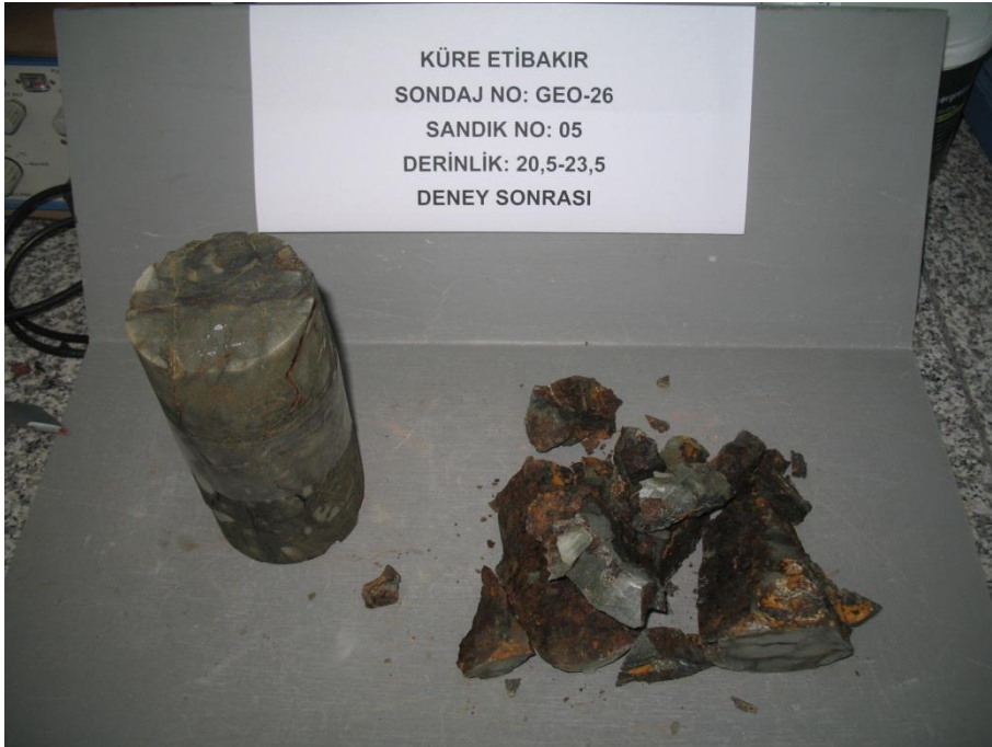
Şekil A.10: Geo-26 tek eksenli basınç ve çekme deneyi sonrası.
