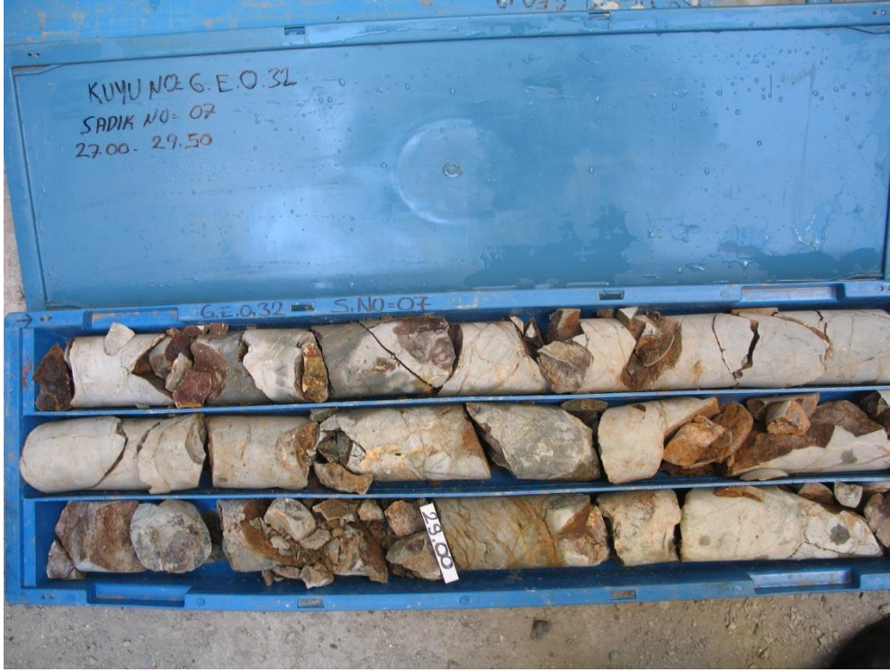
Şekil B.9: Geo-32 tek eksenli ve çekme basıncı deneyi için alınan karot.
