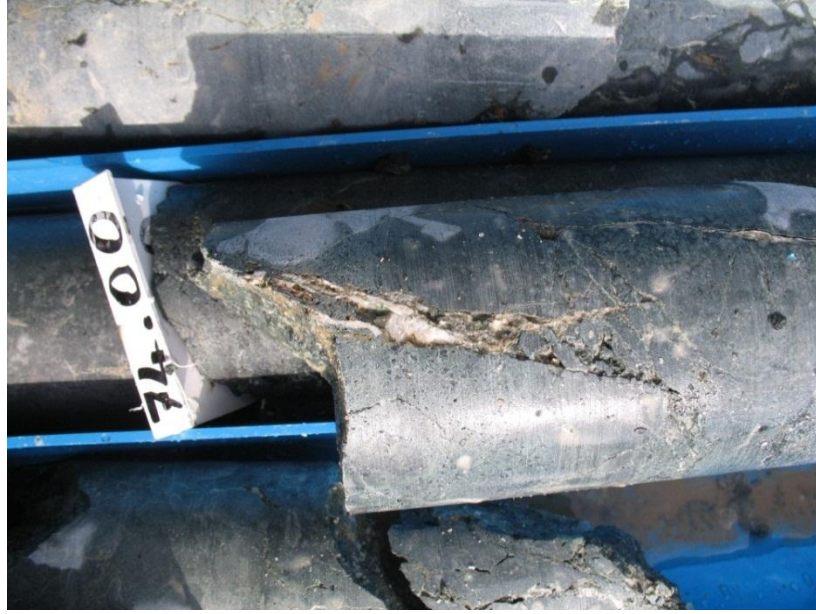
Şekil 5.16: Mz -304 sondajı karot örneğinde bazalt süreksilik açıklığı.
