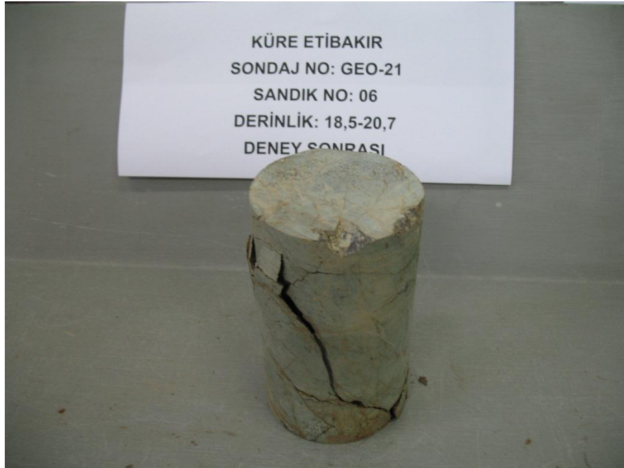
Şekil A.8: Geo-21 tek eksenli basınç ve çekme deneyi sonrası.
