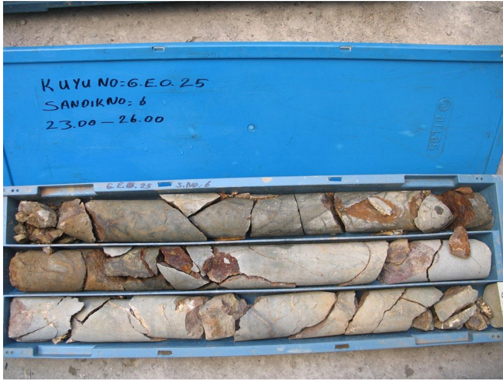
Şekil B.5: Geo-25 tek eksenli ve çekme basıncı deneyi için alınan karot.
