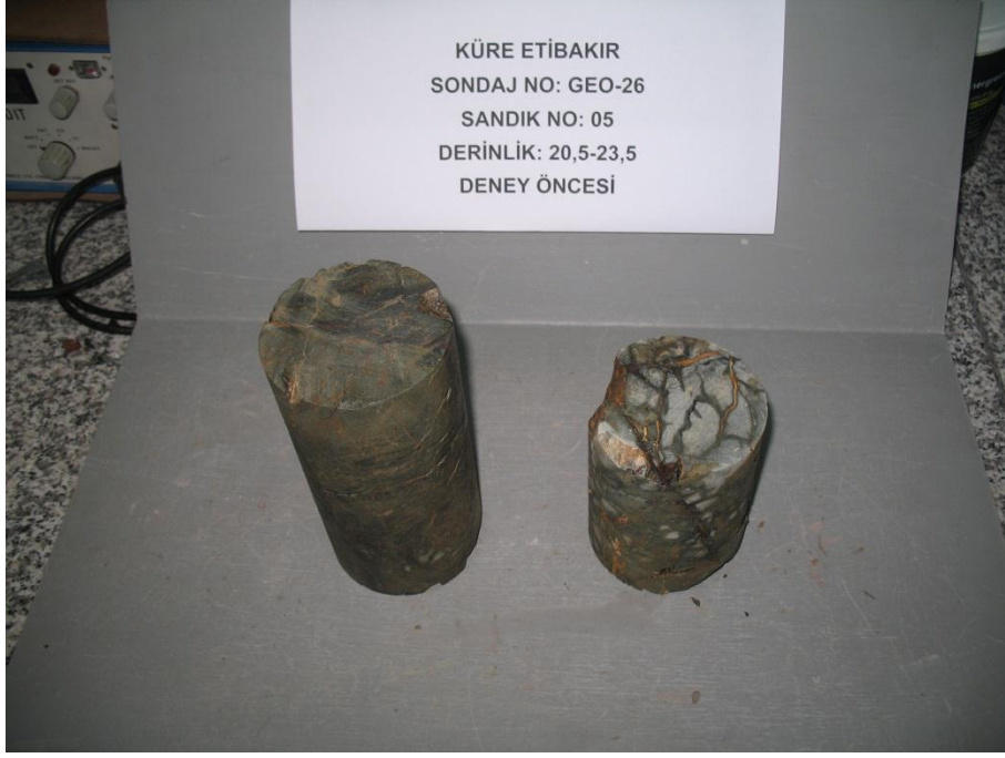
Şekil A.9: Geo-26 tek eksenli basınç ve çekme deneyi öncesi.
