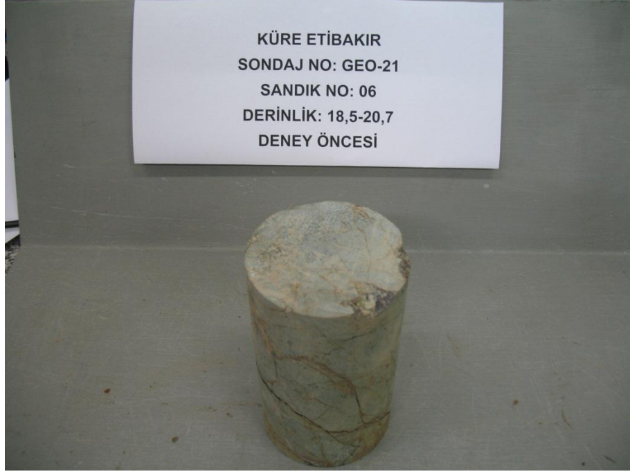
Şekil A.7: Geo-21 tek eksenli basınç ve çekme deneyi öncesi.
