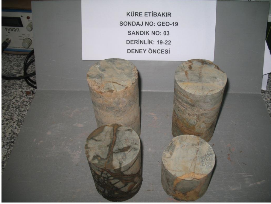
Şekil A.5: Geo-19 tek eksenli basınç ve çekme deneyi öncesi.
