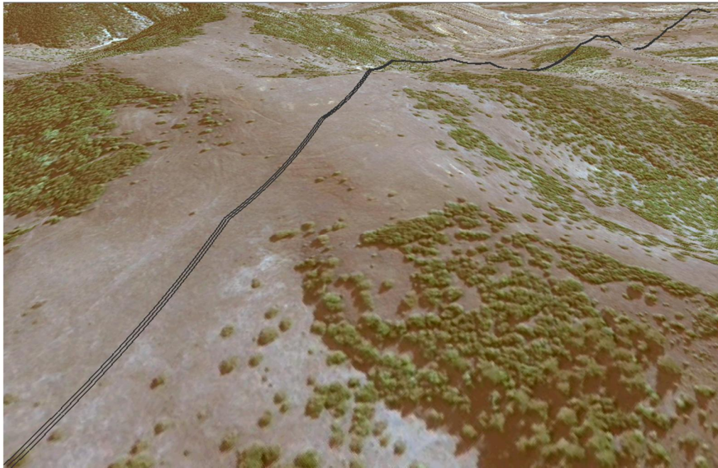
Şekil 4.49. Üç boyutlu ortamda iletken sehimlendirmesinin gösterimi
