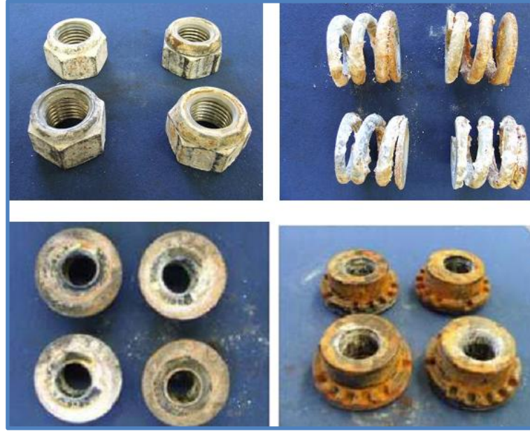
Şekil 3.55 : Şiddetli çevre şartlarının etkisi testi sonrası somun, yay ve pulların durumu[21].
