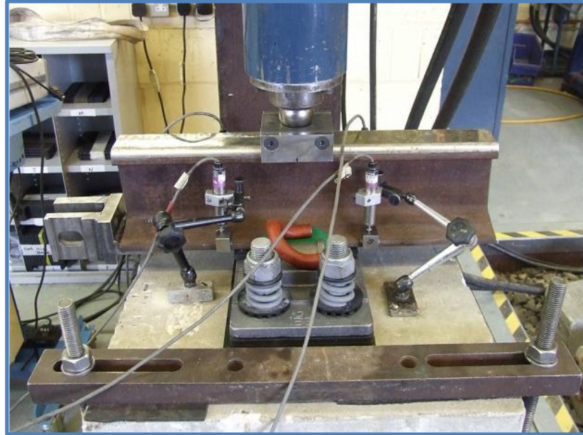
Şekil 3.28 : Montajın dinamik rijitliğinin ölçülmesi testi düzeneği[21].
