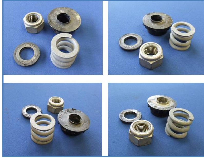
Şekil 3.50 : Tekrarlı yük testi sonrası çelik selet altı pedin üst ve alt yüzeylerinin durumu[21].
