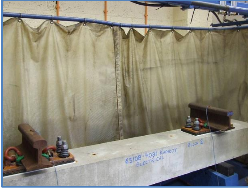
Şekil 3.56 : Elektriksel direnç testinin uygulandığı düzenek [21].
