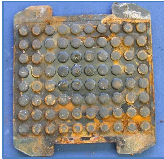
Şekil 3.52 : Şiddetli çevre şartlarının etkisi testi sonrası ray altı pedinin durumu[21].
