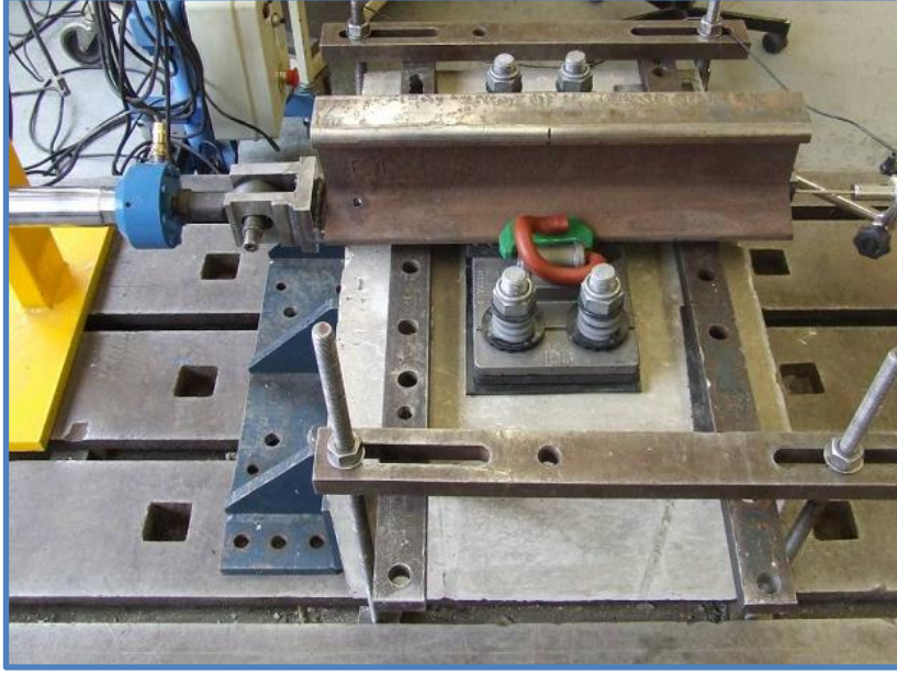
Şekil 3.34 : Boyuna ray direnci testinin yapıldığı düzenek[21].
