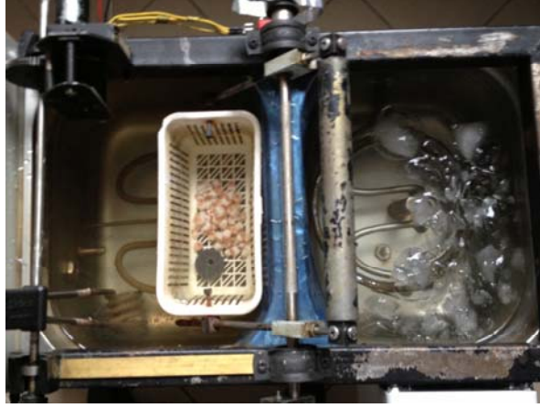
Şekil 3.12. Örnekler ısı döngü işleminin uygulanması
