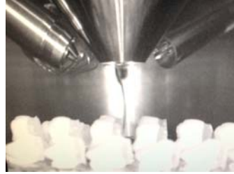
Şekil 3.11. İncelenen yüzeylerin TEM tüpüne dik konumda yerleştirilmesi
