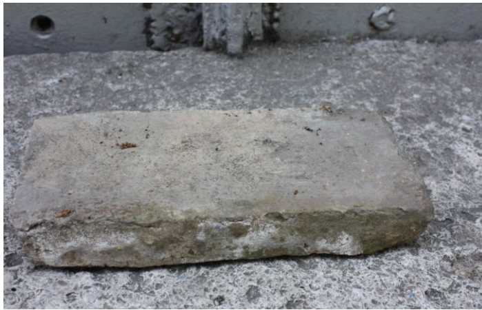
Şekil 6.5 : Duvar örgüsünde kullanılan 22x11x3 cm boyutlarındaki harman tuğlası.
