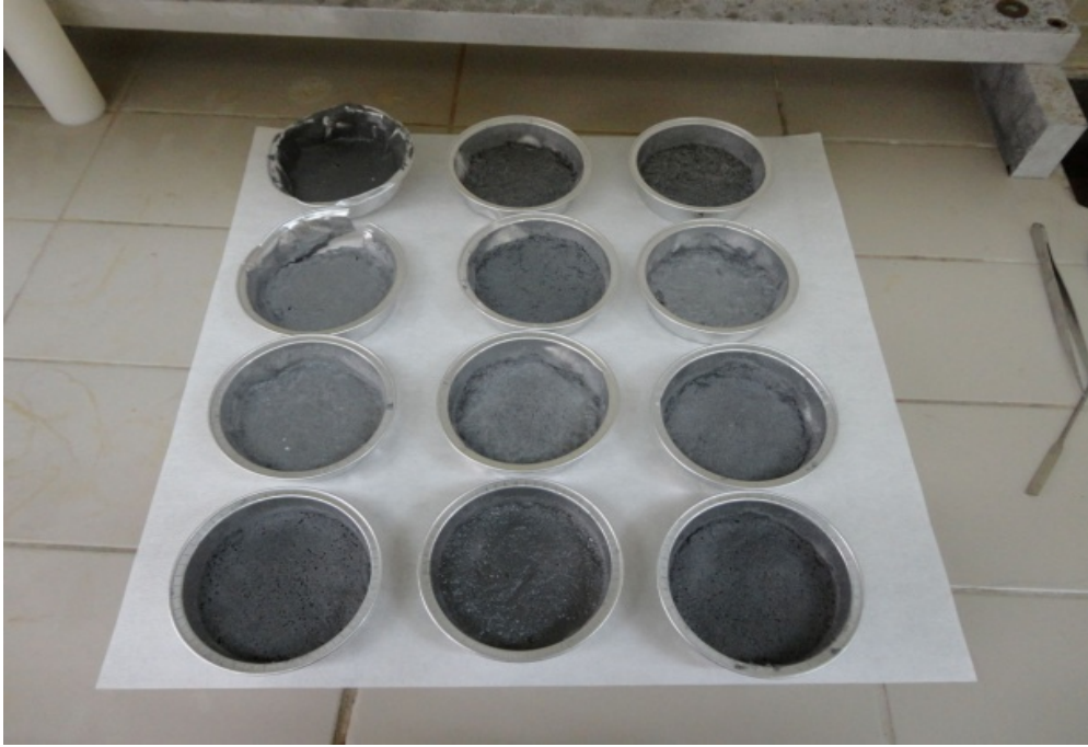
Resim 3.3. Numunelerin 60 °C sıcaklık ve 7 gün boyunca kürleşmesinden sonraki görüntüleri
