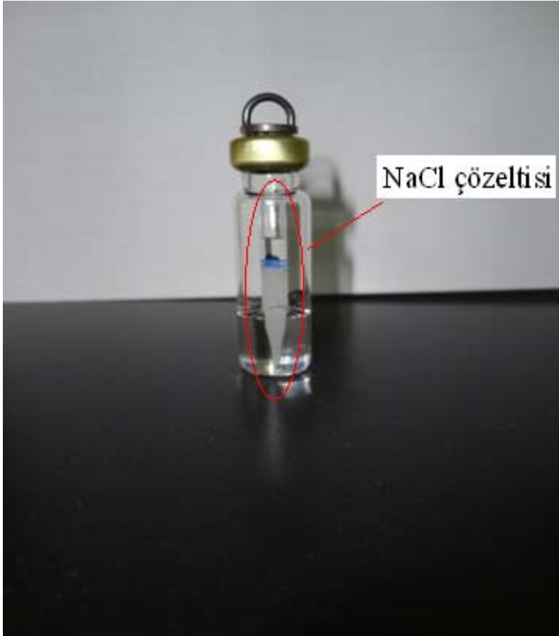
Resim 3.7. MC ampulleri içerisinde ince tüpler içine konulan doymuş NaCl çözeltisi ile %75 nemli ortamın oluşturulması
