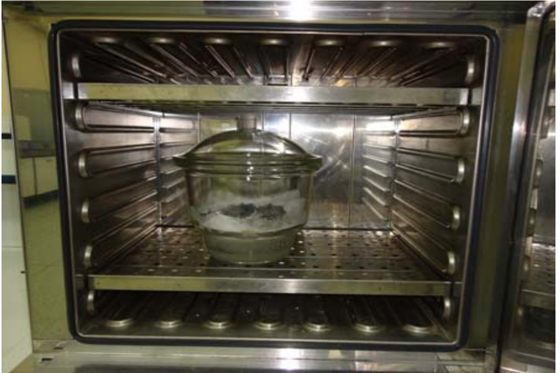
Resim 3.5. Numuneleri etüvde 90 °C sıcaklık, %75 nem ve ortam oksijeninde hızlı yaşlandırma düzeneği
