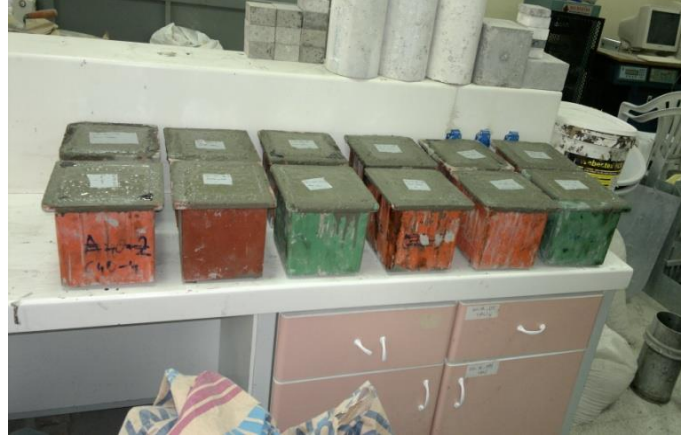
Şekil 3.8. Sertleşmeye bırakılan beton numuneler
