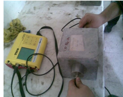
Şekil 3.14. Ultrases geçiş hızı değerlerinin elde edilmesi
