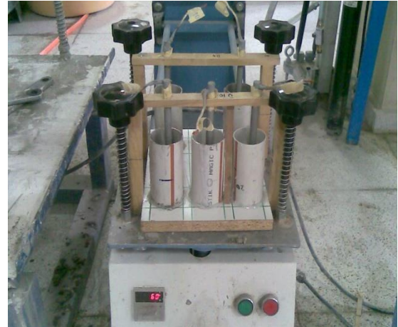
Şekil 3.19. Silindir kalıpların şok masasına yerleştirilip beton dökümüne hazırlanması
