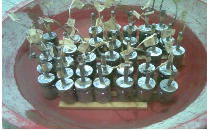
Şekil 3.23. Korozyon numunelerinin % 5'lik NaCl çözeltisinde korozyon ortamına maruz kalması
