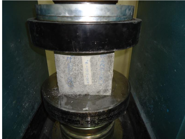
Şekil 3.17. Basınç dayanım cihazı ve basınç dayanım değerlerinin belirlenmesi
