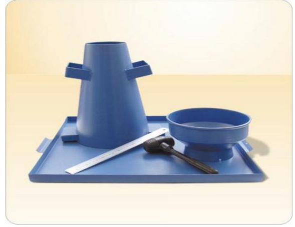
Şekil 3.11. Çökme hunisi (Slump) deney aparatları ( Utest, 2012)
