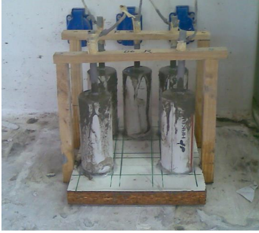
Şekil 3.20. Beton dökümü tamamlanan silindirik korozyon numunesi
