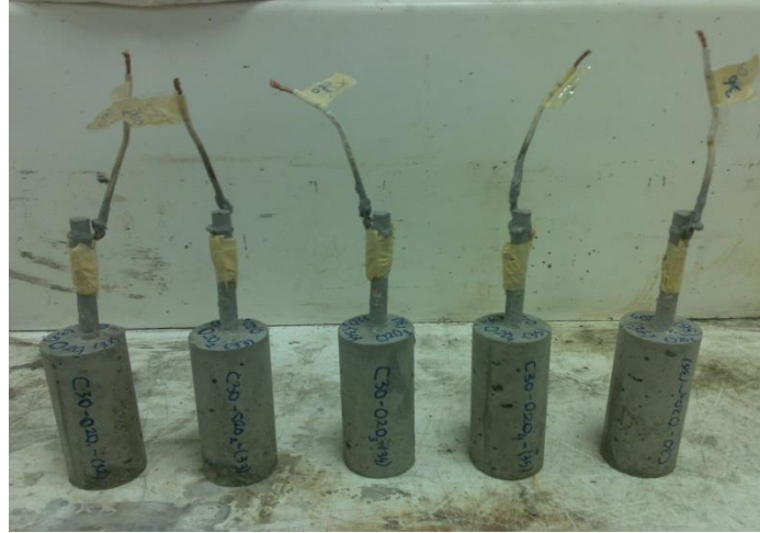
Şekil 3.22. Kalıptan çıkarılmış silindirik korozyon numuneleri
