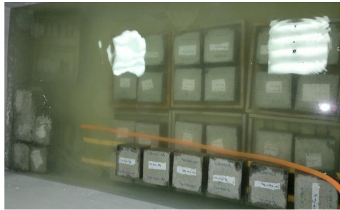
Şekil 3.9. Sertleşmiş beton numunelerin kür havuzuna yerleştirilip kür edilmesi
