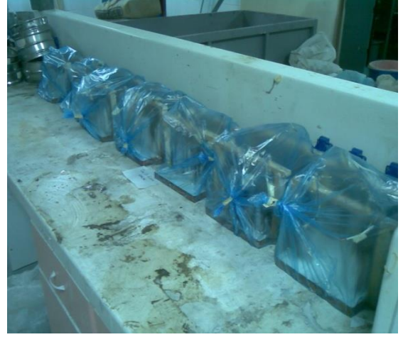
Şekil 3.21. Nemini korumak üzere plastik örtülerle kaplanan silindirik korozyon numuneleri
