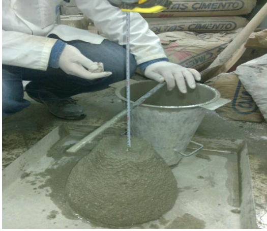
Şekil 3.10. Çökme hunisi (Slump) değerlerinin belirlenmesi
