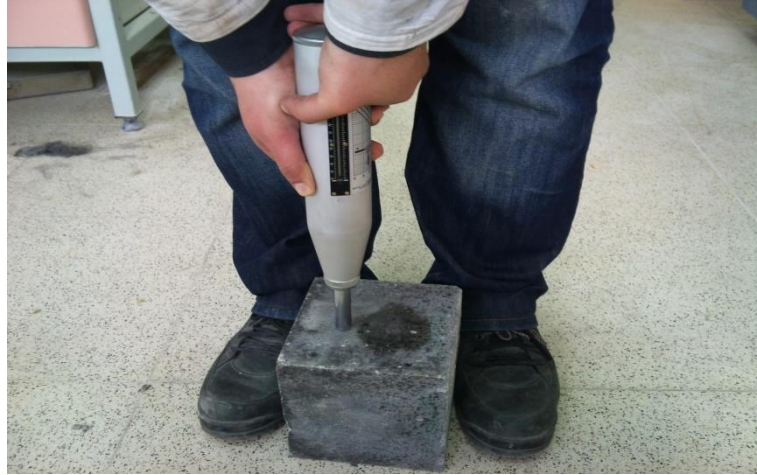
Şekil 3.15. Schmidt çekici ile beton numunelerin yüzey sertliklerinin belirlenmesi
