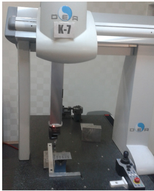
Resim 5.1. Delik çap ve daireselliklerinin ölçüldüğü CMM tezgahı
