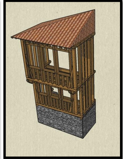
Şekil 41-42-43: Bey Sokak/73 Ada 30 Parsel Konut Konstrüksiyon Çizimi (Bey Sokak Yapım Sistemi Detayı )
