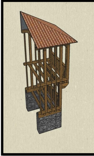
Şekil 41-42-43: Bey Sokak/73 Ada 30 Parsel Konut Konstrüksiyon Çizimi (Bey Sokak Yapım Sistemi Detayı )
