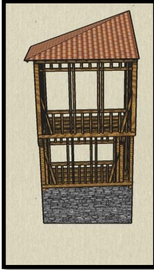
Şekil 41-42-43: Bey Sokak/73 Ada 30 Parsel Konut Konstrüksiyon Çizimi (Bey Sokak Yapım Sistemi Detayı )
