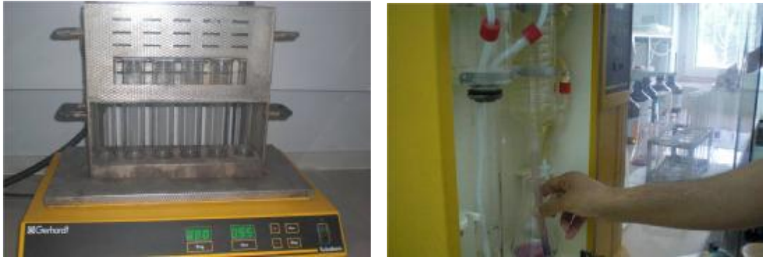
Şekil 3.14. Bitki yapraklarında azot (N) analizi Kjeldal yöntemine göre yapılmıştır
