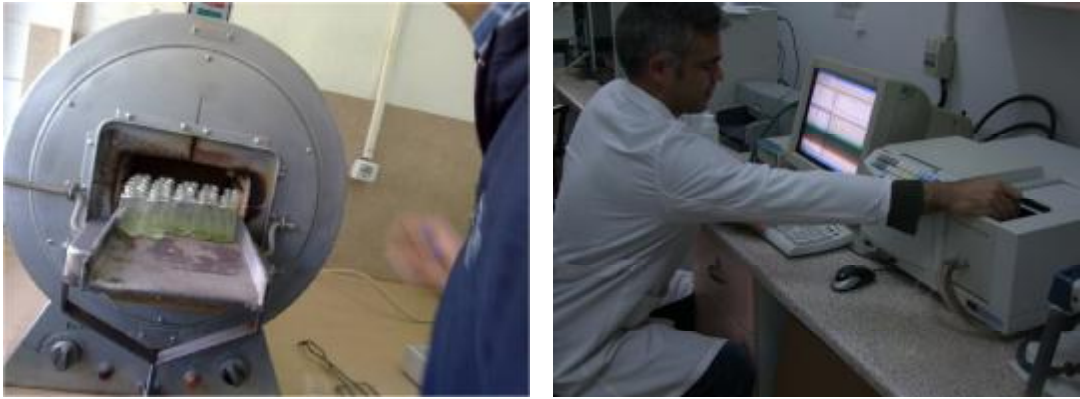
Şekil 3.13. Yapraklarda makro ve mikro element analizlerinde kullanılan kül fırını ve Atomik Absorpsiyon Spektrometre cihazından görüntüler
