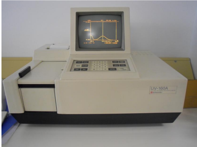
Resim 5: Örneklerin absorbasının spektrofotometrede ölçülmesi
