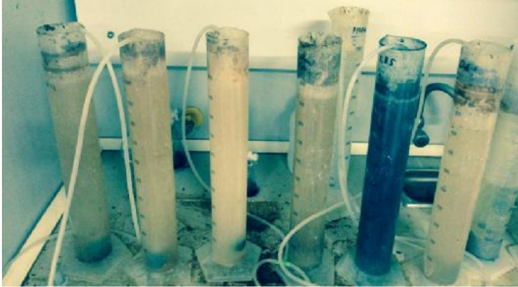
Şekil 3.1. Aktif Çamurun Aklimize Edilmesinde Kullanılan Havalandırılmalı Mezürler
