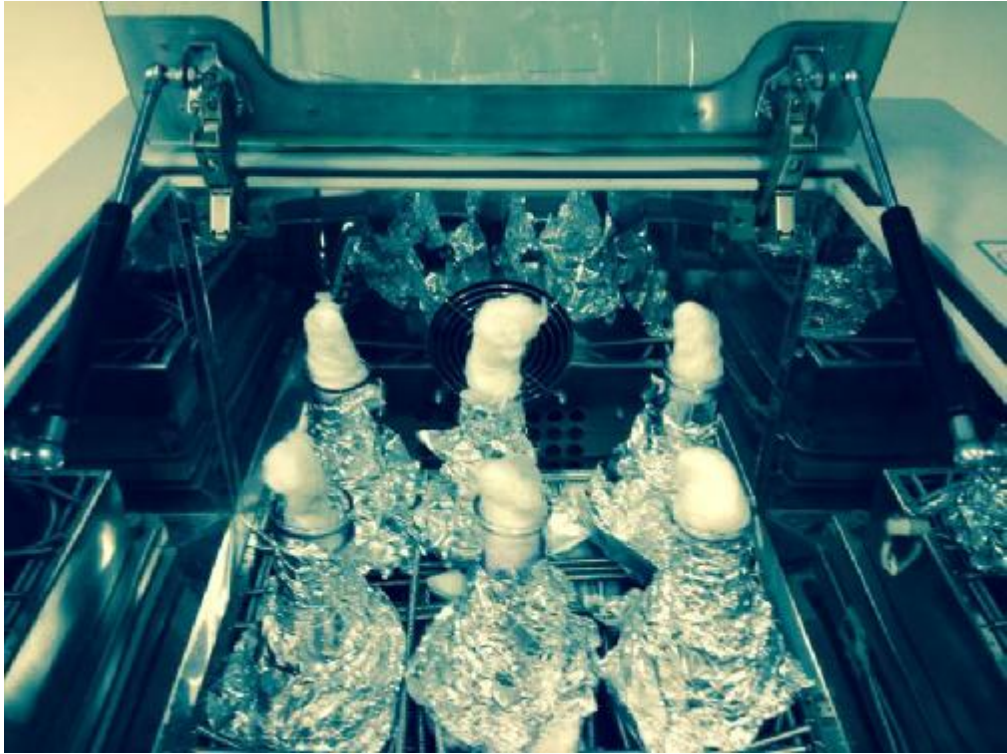
Şekil 3.2. Aktif Çamur ile Yapılan Çalışmalarda Kullanılan Kesikli Reaktörler
