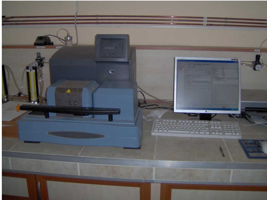
Şekil 3.5 : Rikagu™ SDT Q600 termal analiz cihazı (İTÜ Metalurji ve Malzeme Mühendisliği Partikül Malzeme Laboratuvarı)
