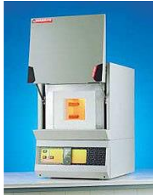
Şekil 3.4 : Cam sentezinde kullanılan Carbolite™ fırın (İTÜ Fizik Mühendisliği Bölümü, Lazer Malzeme Sentez ve Optik Laboratuvarı)
