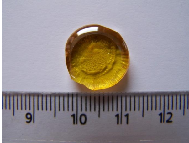
Şekil 3.1 : %90 mol \text{TeO}_2 +%10 mol \text{TiO}_2
