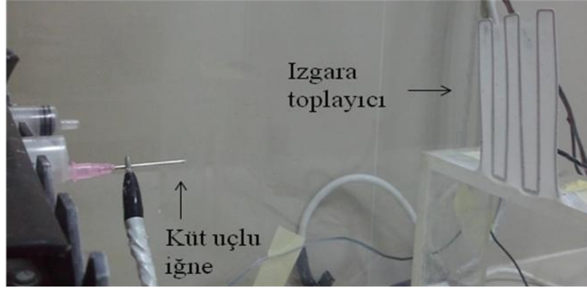
Şekil 2.4. Deneyde kullanılan elektro-eğirme düzeneği
