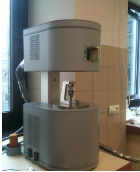
Şekil 2.6. 01dB – Metravib marka DMA50 model DMA cihazı
