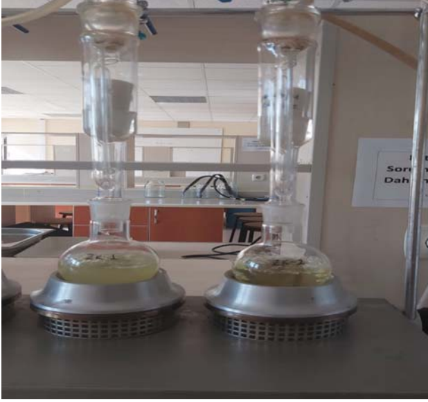
Şekil 3.2.3.1. Bal kabağı çekirdeğinde yağ ekstraksiyonunda kullanılan soxhlet cihazı.
