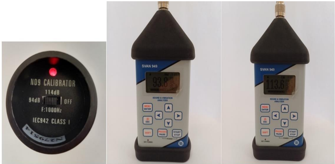
Şekil 5.18 : Kalibrasyon cihazı ve cihaz ölçümleri.
