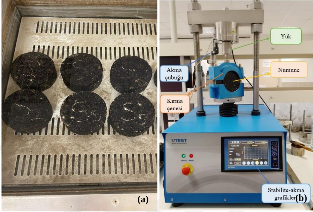
Şekil 2.23: (a) Su banyosunda bekletilen briket numuneleri (b) marshall deney cihazı.
