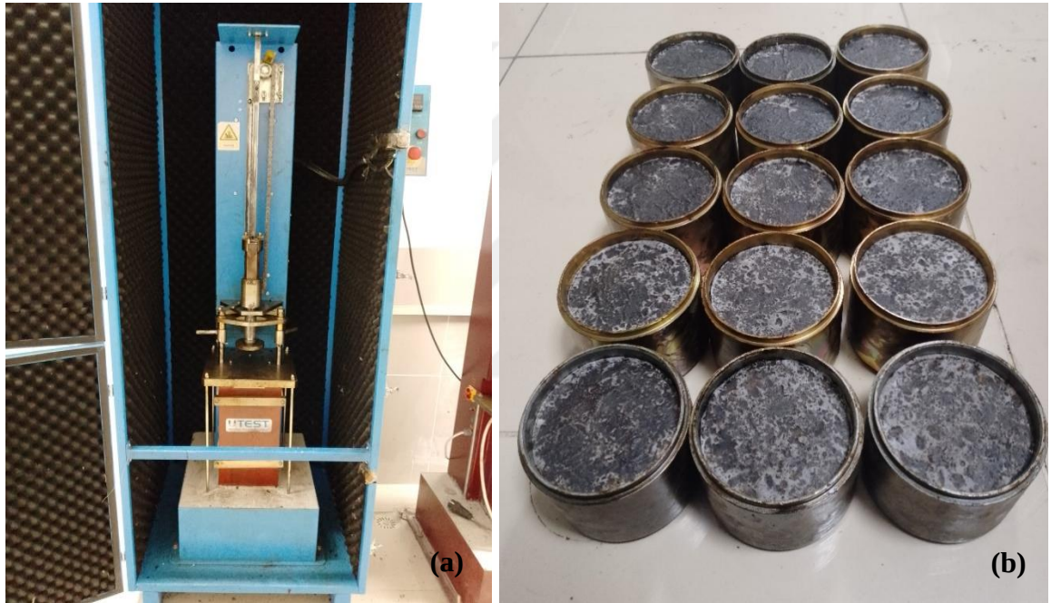
Şekil 6.2: (a) Numunenin Marshall tokmağında sıkıştırılması (b) kalıpta bekletilmesi.
