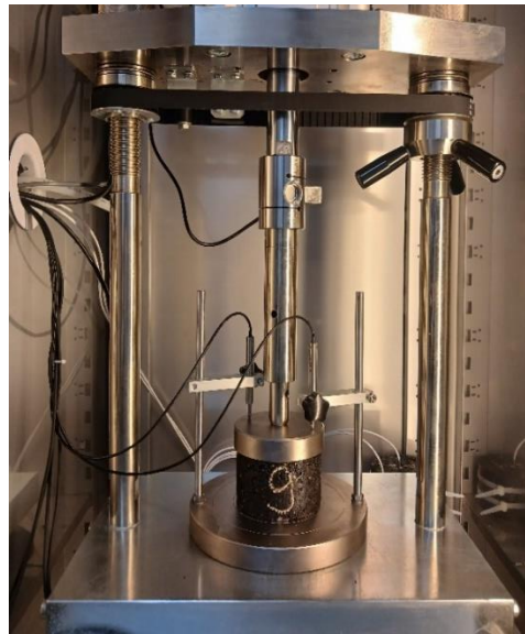
Şekil 2.30: Sünme deneyine maruz bırakılan briket numunesi.
