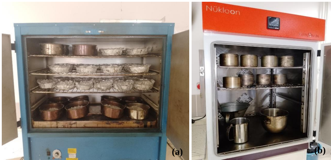
Şekil 6.1: (a) Agreganın etüvde ısıtılması (b) bitüm ve kalıpların etüvde ısıtılması.
