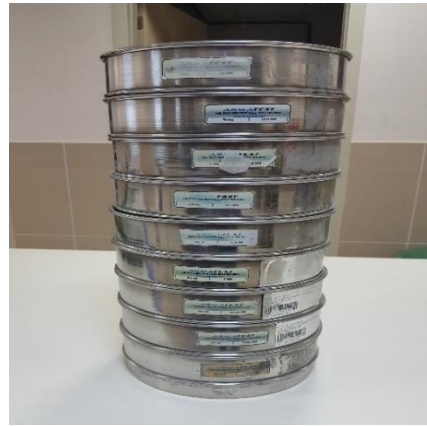
Şekil 2.2: Elek analizi deneyinde kullanılan elekler.
