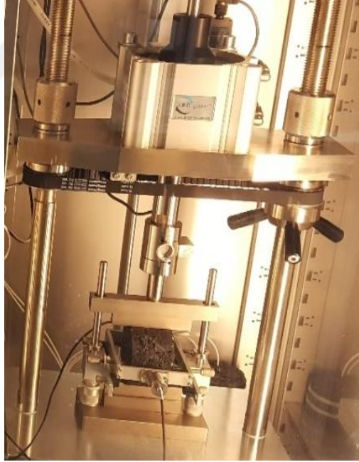
Şekil 2.28: ITSM deneyine maruz bırakılan numune.
