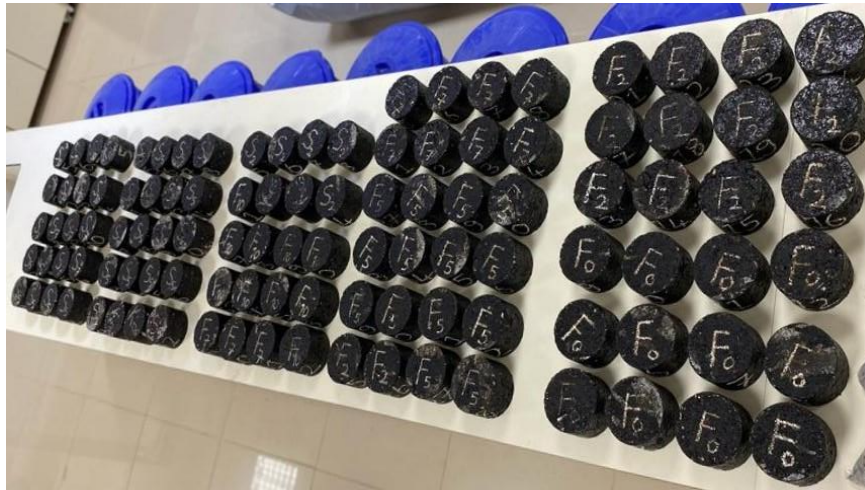
Şekil 6.9: Hazırlanan BSK numunelerinin bir kısmı.
