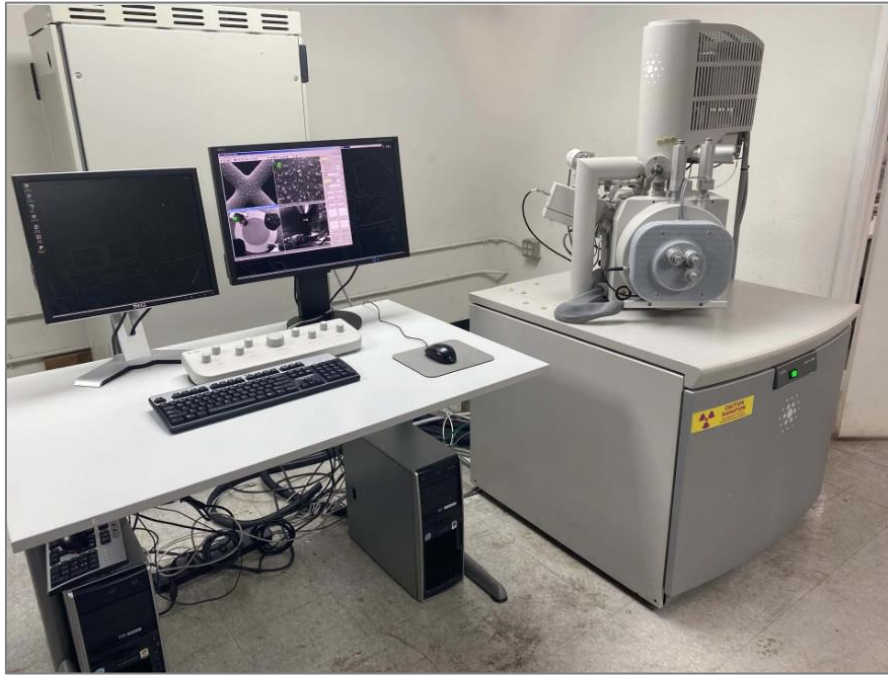
Resim 3.7. Yüksek çözünürlüklü taramalı elektron mikroskobu (QUANTA 400F Field Emission SEM, Philips/FEI, Hillsboro, OR, USA)
