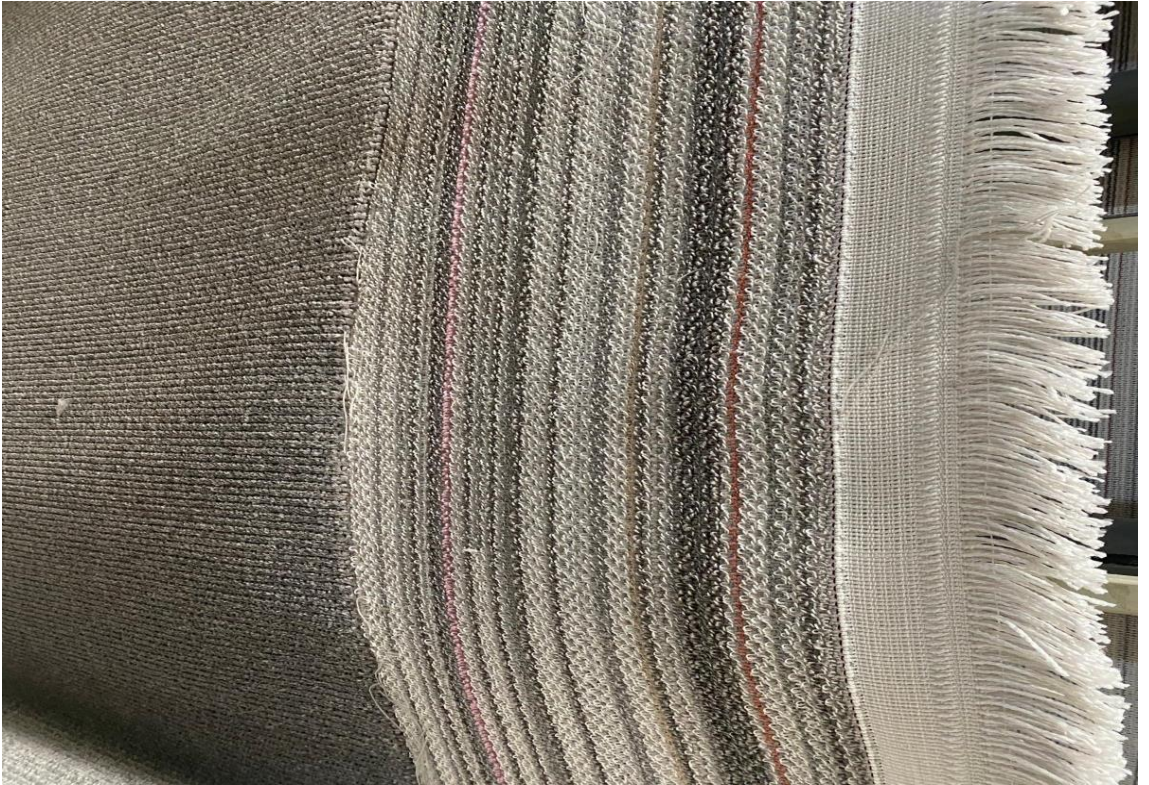
Şekil 5.12. Boşluk doldurma yapılan fire kısım
