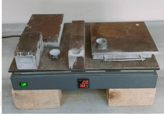
Şekil 19: Isıtıcı Tabla ve Kalıpların Isıtılmasına Ait Örnek Bir Görüntü.
