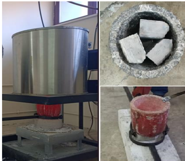
Şekil 16: Çan Tipi Ocağın Ergitme İşlemin Yapılması
