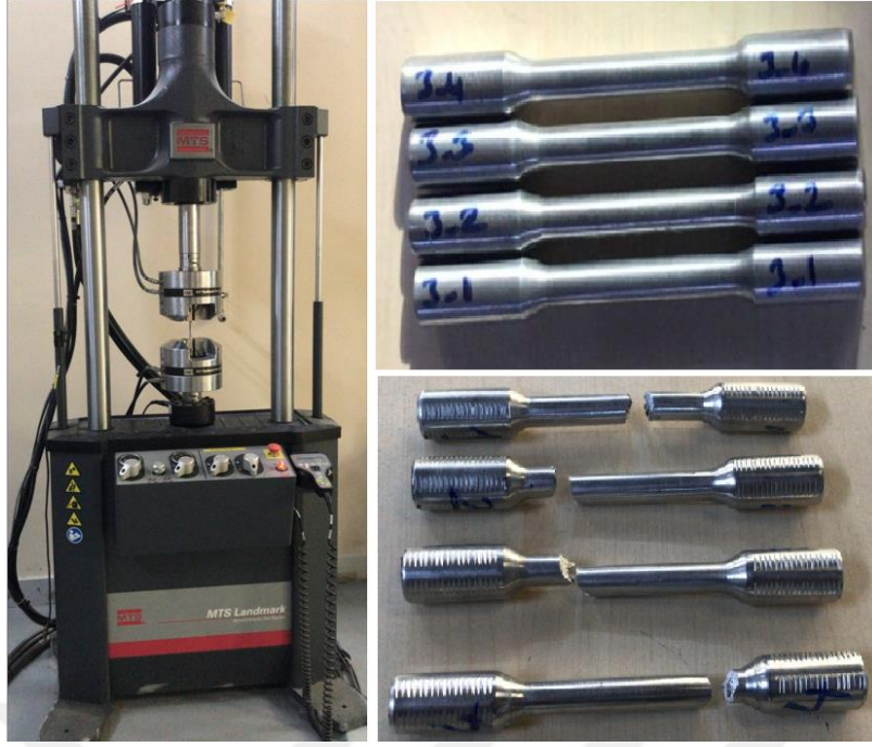
Şekil 35: Çekme Testi Cihazı ve Çekme Çubuğu Numuneleri
