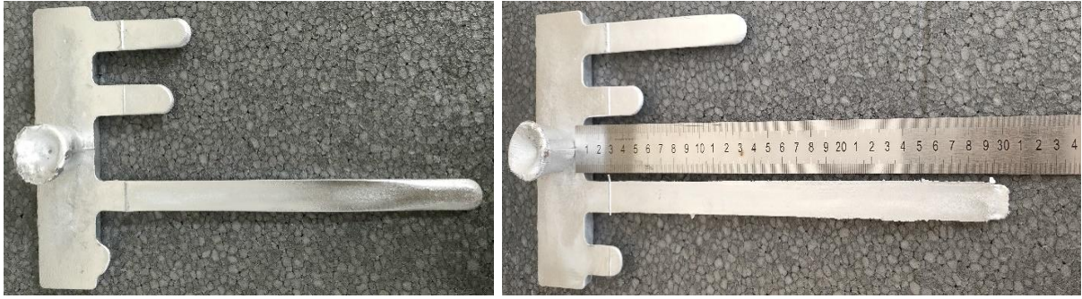
Şekil 25: Sıvı Metal İlerleme Mesafelerin Numunesinin Ölçülmesi
