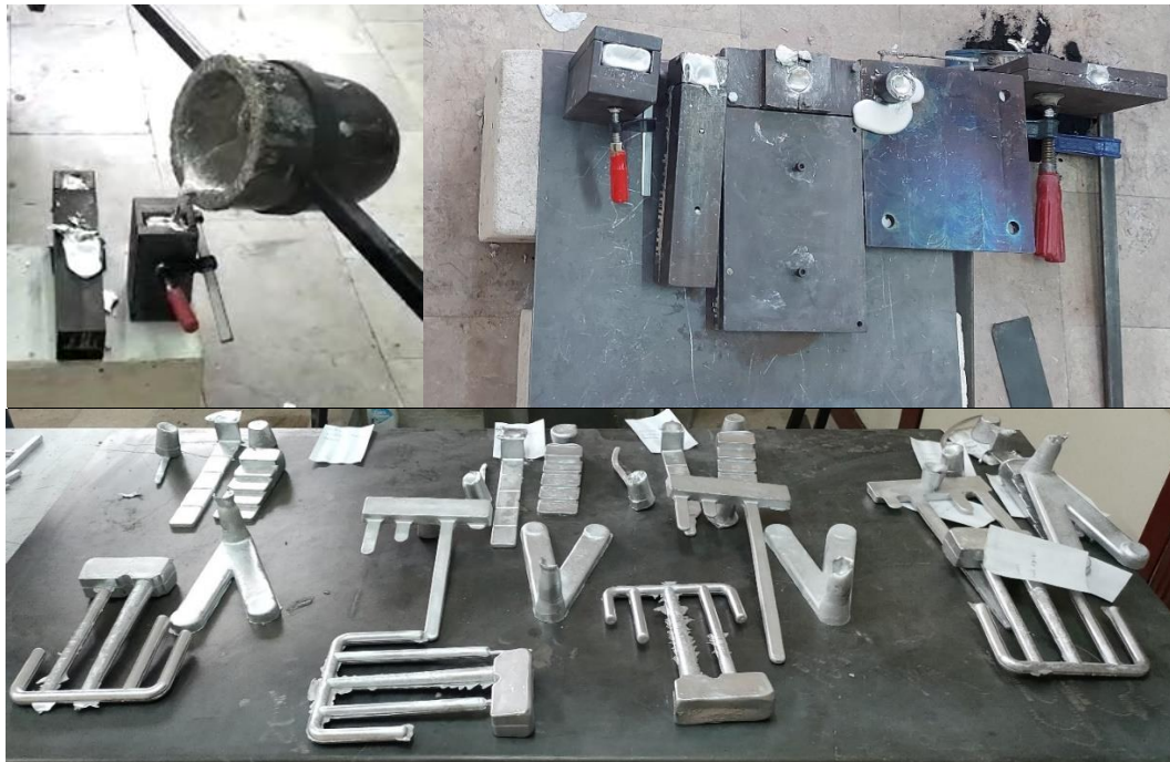
Şekil 20: Sıvı Metalin Kokil Kalıplara Dökümü ve Elde Edilen Numuneler
