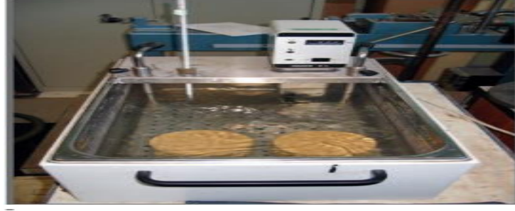
Şekil 2.24 Bitümlü numunelerin 40°C'de 72 saat süreyle hızlandırılmış şartlandırılması (Road Research Center Brussels 1965)
