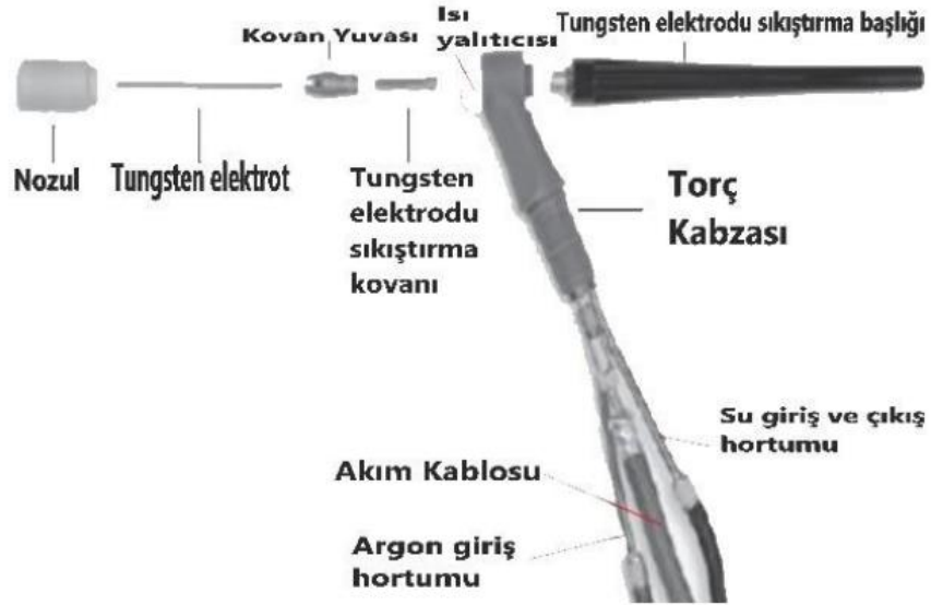
Şekil 3.4: TIG Kaynak torcu ve elemanları [22].
