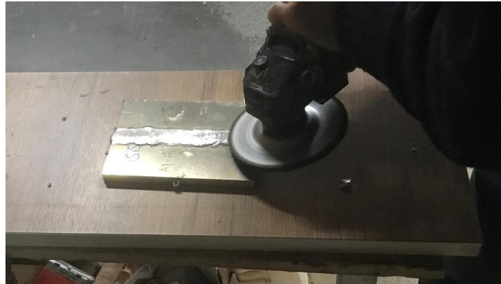
Şekil 5.7: Kaynak işleminden sonra numune yüzeyi temizleme işlemi.
