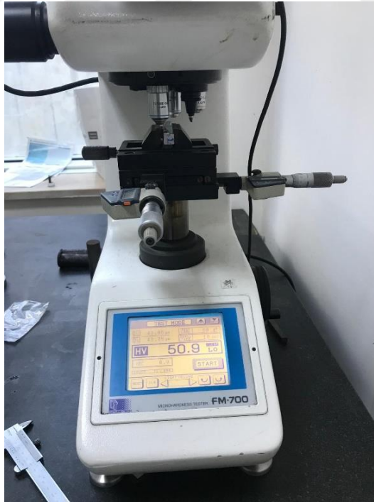
Şekil 5.13: Sertlik testlerinin yapıldığı mikro sertlik cihazı.
