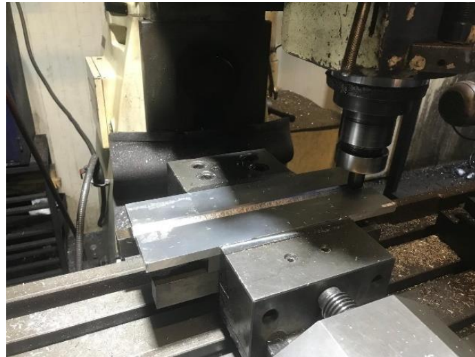
Şekil 5.2: Numunelere freze tezgahında kaynak ağzı açılması.
