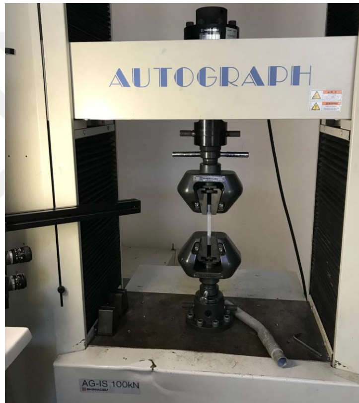
Şekil 5.14: Çekme testlerinin yapıldığı çekme cihazı.
