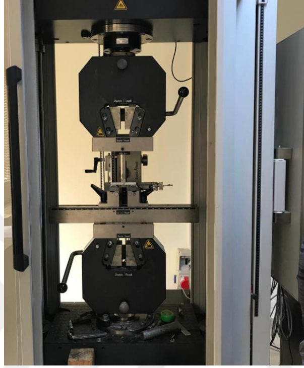
Şekil 5.15: Eğme testlerinin yapıldığı eğme cihazı.
