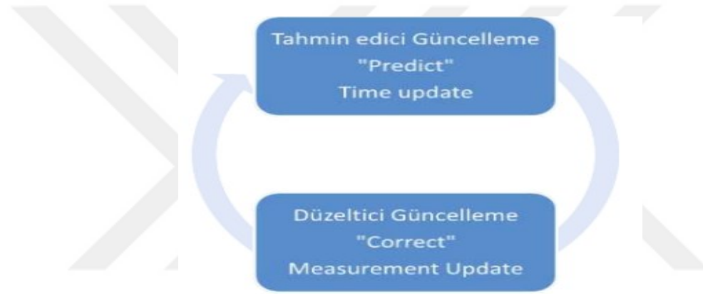
Şekil 3.21. Ayırık kalman filtre döngüsü (Gayıroğlu,2012)
