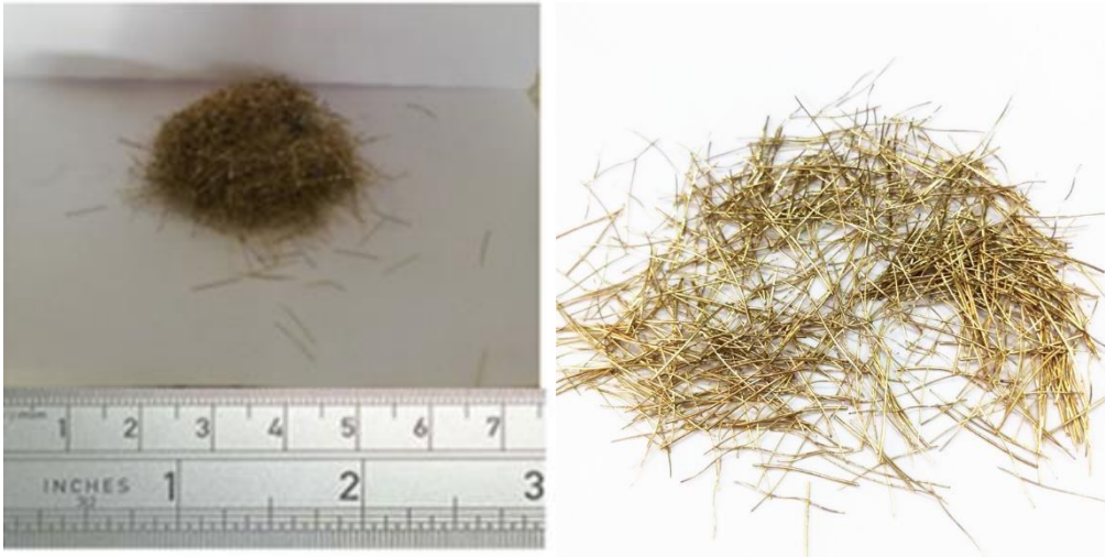
Şekil 3.1: Bakır kaplı çelik lif
