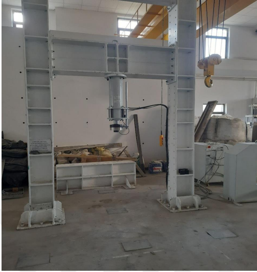
Şekil 3.9 : Beton boruların mekanik özelliklerini incelenmek için kullanılan test cihazı
