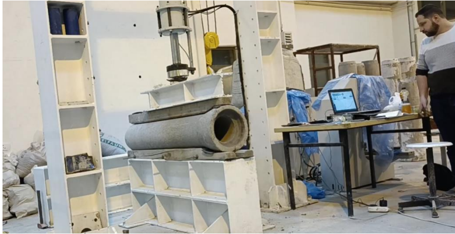
b) Beton borunun yükleme sistemi altındaki yakın plan görüntüsü
