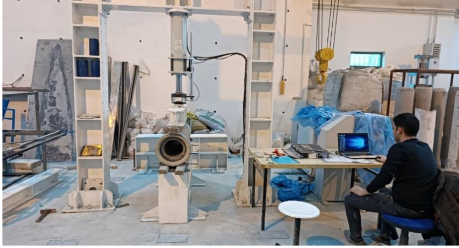
c) Beton boruların dayanım testi düzeneđi
