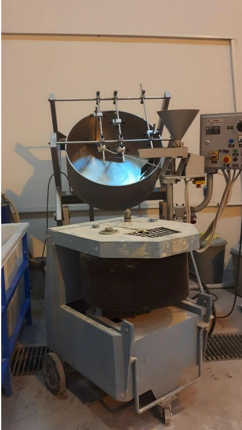
Şekil 3.4 : YFC, agrega ve çelik lif malzemelerinin karıştırılması
