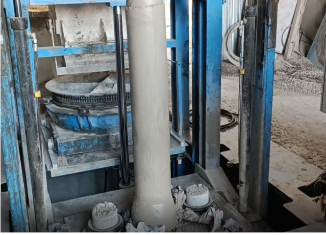
Şekil 3.6 : Üretim sornası beton borular
