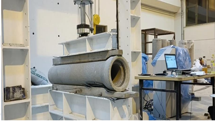
a) Yükleme sistemi altında test edilen beton boruların yandan görünümü
