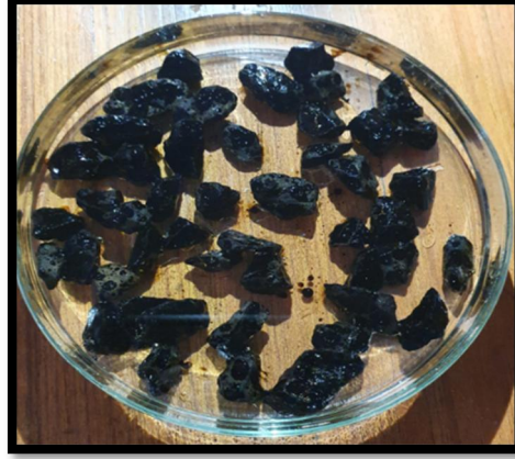
Şekil 3.17. Laleli Taşocağı Agregası ve Kırıkkale TÜPRAŞ rafineri bitümü karışımının (katkısız) soyulma dayanım görseli.
