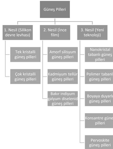
Şekil 3.6 Güneş pili teknolojilerinin sınıflandırılması.
