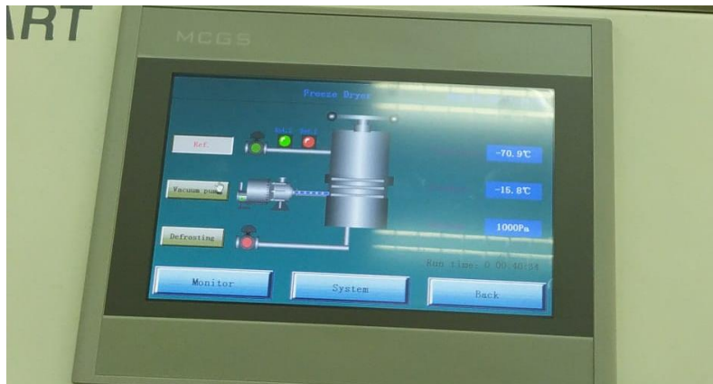
Şekil 5.8 Dondurarak kurutucunun panel bölümü
