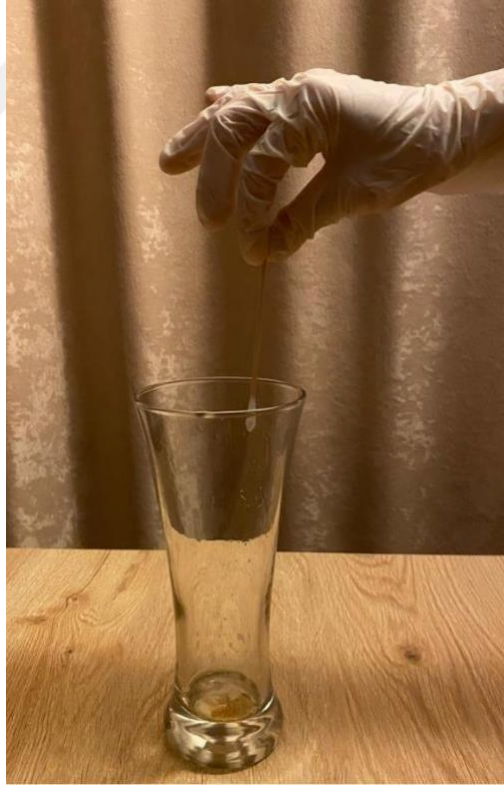
Şekil 17: Bardak Cidarından Kalıntı Alınması
