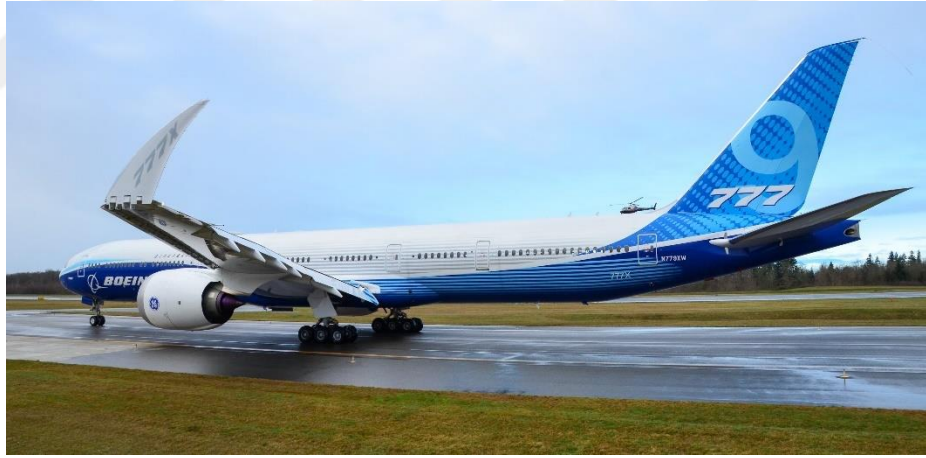
Şekil 2.4. Boeing 777X – katlanabilen kanat ucu
