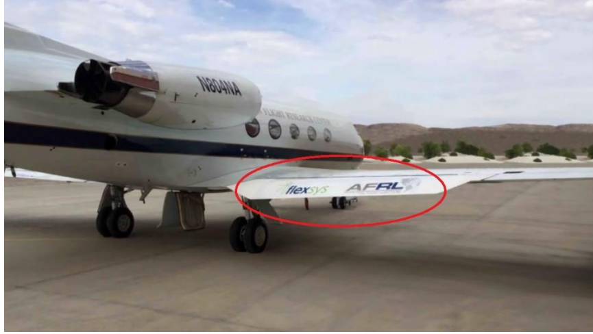
Şekil 2.17. FlexSys Inc. Firmasının tasarladığı esnek kanat flapı
