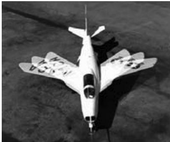
Şekil 2.6. Bell X-5 uçağının geçiş fazları
