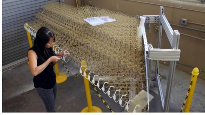
Şekil 2.21. MADCAT projesinde kullanılan modüler bloklar
