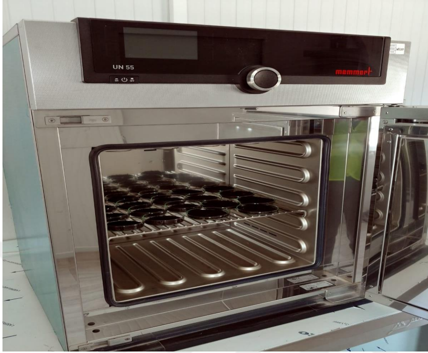
Şekil 3.2. Memmert Un 55 etüv cihazında örneklerin kurutulması
