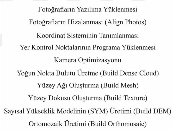
Şekil 3.26. Agisoft Metashape işlem adımları.
