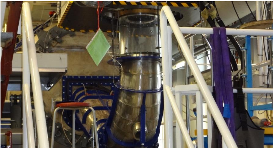
Şekil 1.9 : Francis türbin / pompa türbin modelinin test donanımı [52].
