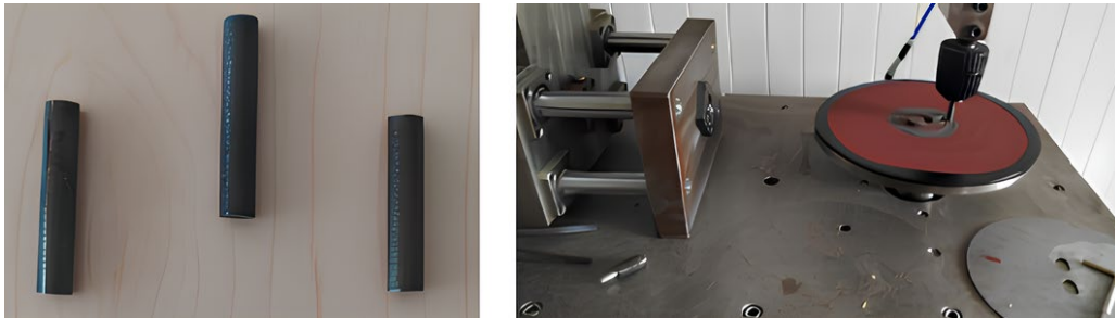
Resim 3.4. Aşınma test numuneleri ve test cihazı
