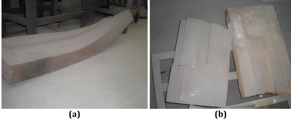
Resim 2.1. Servis koşullarında hasara uğramış kırıcı palet örnekleri
