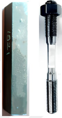
Resim 3.2. Y-Bloktan çıkarılmış deney numunesi ve işlenmiş çekme numunesi
