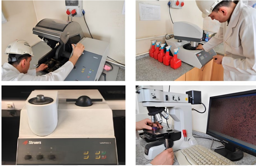
Resim 3.5. Numune hazırlama seti (otomatik kesme, parlatma ve bakalite alma cihazı) ve optik mikroskop
