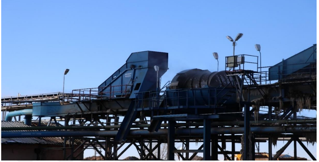
Şekil 2.15. Şeker Pancarının Ot Tutucu ve Taş Tutuculardan Geçmesi İşlemi
