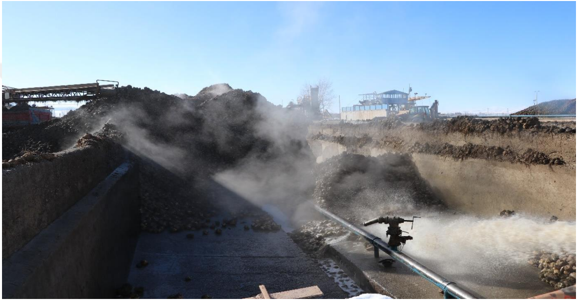
Şekil 2.14. Beton Silolardan Şeker Pancar Boşaltma İşlemi
