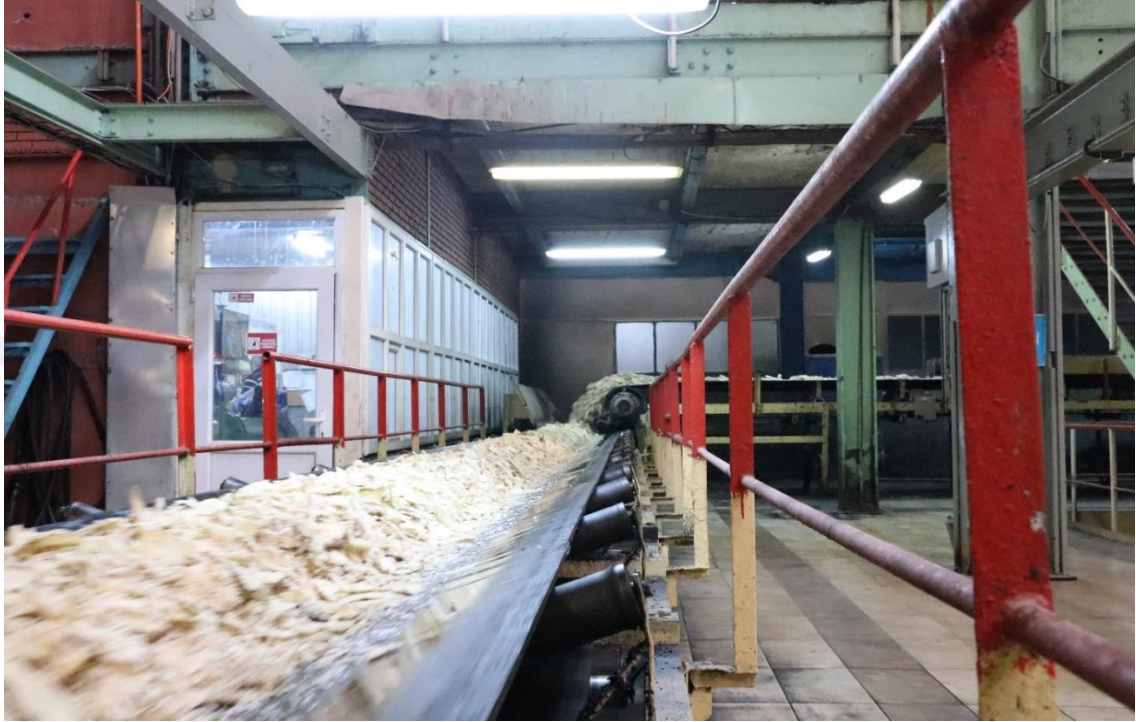
Şekil 2.17. Şeker Pancarının Kıyım Bandından Haşlama Teknesine Aktarılması İşlemi
