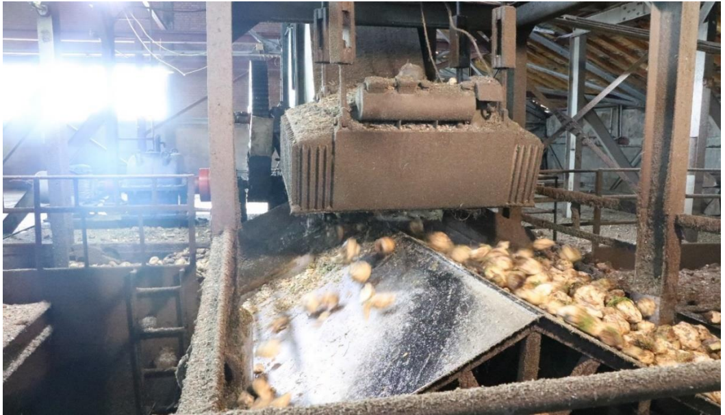
Şekil 2.16. Şeker Pancarının Bunkere Boşaltılma İşlemi
