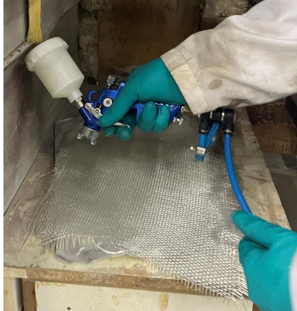
Şekil 2.29. Püskürtme methodu ile sizing'in elyaf yüzeyine uygulanması.
