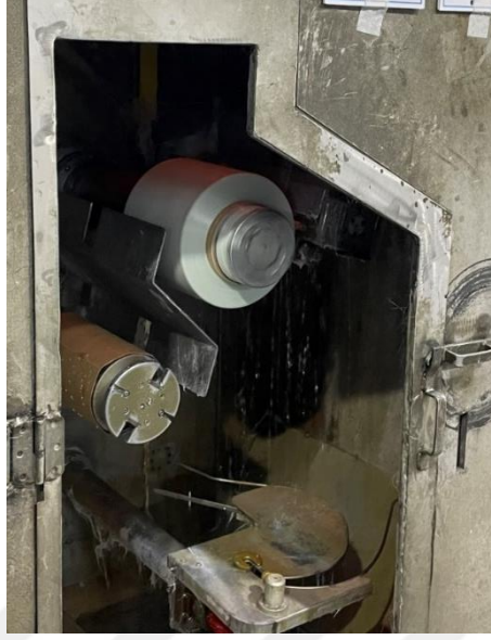
Şekil 1.5. Sizing kaplanmış cam elyafların bir bobine sarılma işlemi.
