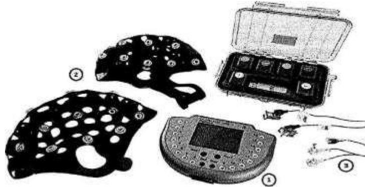
Şekil 5: 1. Elektriksel sinyal güçlendirici, 2. Başlık, 3. Elektrotlar
