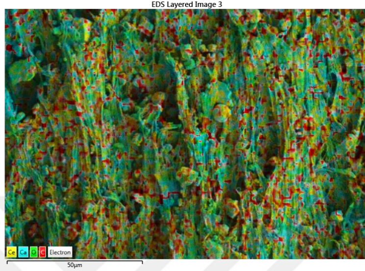
Şekil 7.41. %70 kalsit katkılı GD AYPE + %30 DM-3 ün EDS analizi renklendirilmiş yüzey görüntüsü
