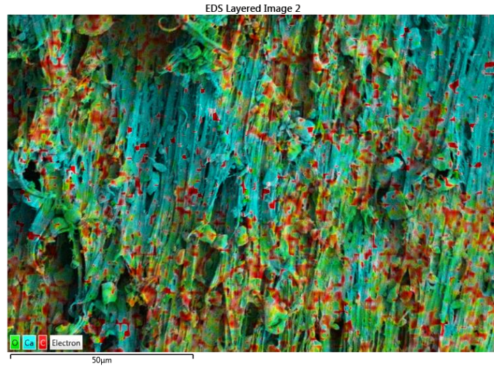
Şekil 7.26. %70 kalsit katkılı GD AYPE + %30 DM-1 in EDS analizi renklendirilmiş yüzey görüntüsü
