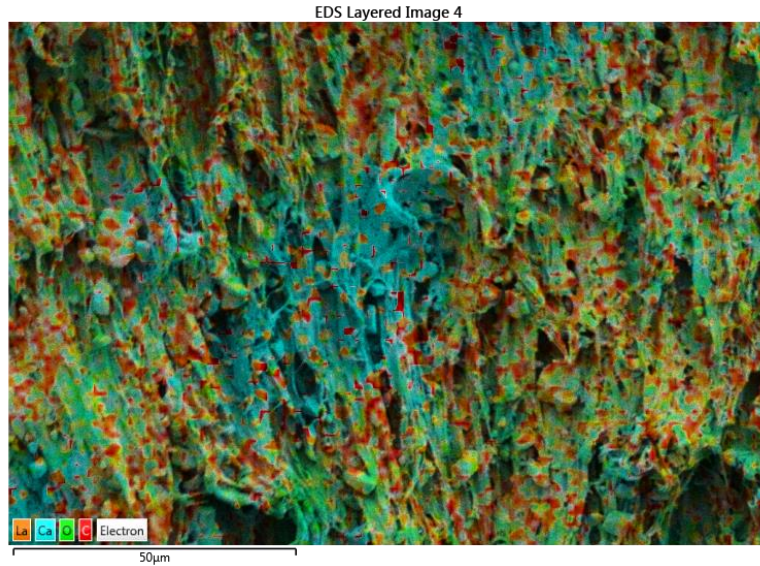
Şekil 7.33. %70 kalsit katkılı GD AYPE + %30 DM-2 nin EDS analizi renklendirilmiş yüzey görüntüsü
