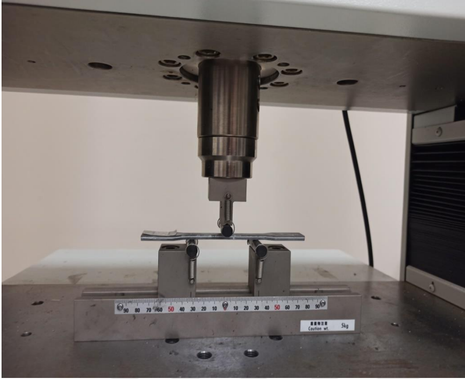
Resim 6.10. Eğilme deneyi (Orijinal)
