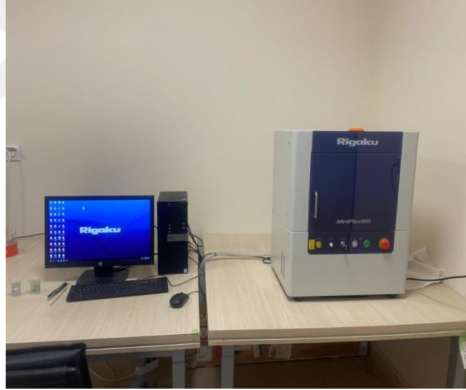
Resim 6.14. Rigaku miniflex60 marka kırınım ölçer (XRD) cihazı (Orijinal)
