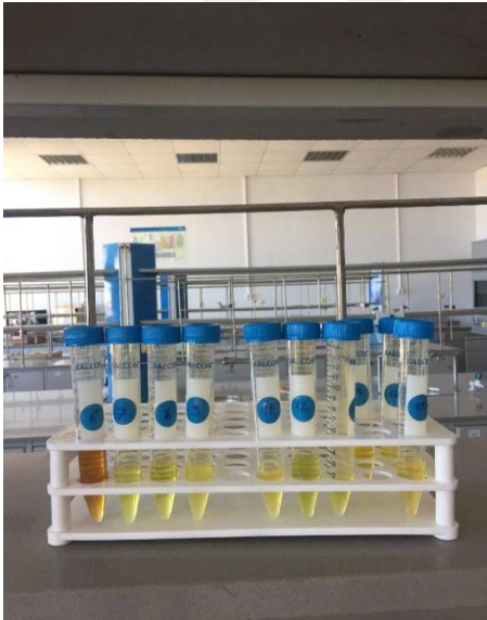
Şekil 11. Ruj örneklerinin asit karışımı ile çözünürleştirilmesi işlemi
