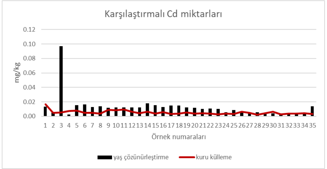
Şekil 37. Yaş çözünürleştirme ve kuru külleme yöntemlerinde tespit edilen kadmiyum miktarlarının karşılaştırılması
