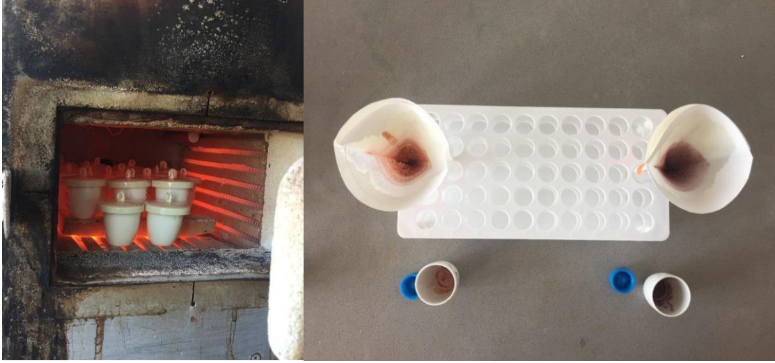
Şekil 12. Kül fırınında külleme ve inorganik ortama aldıktan sonra süzme işlemi
