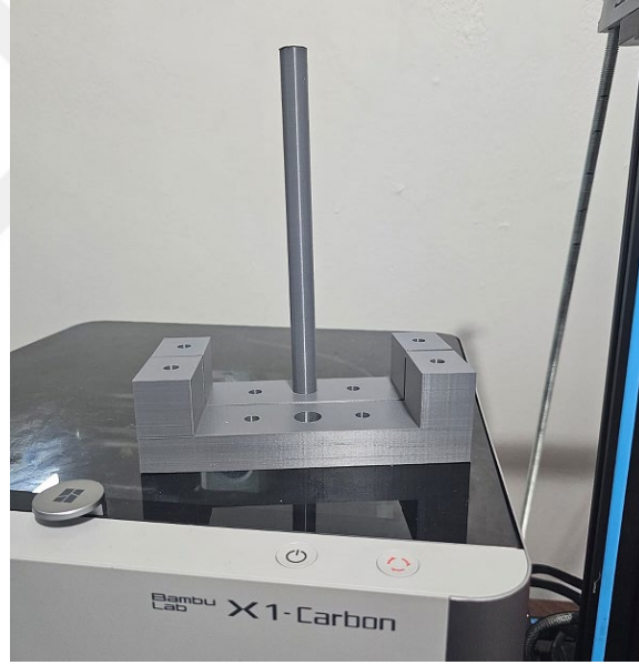
Şekil 6.7. 3B Basım Sonrası Elde Edilen Yataklama Elemanları ve Mil
