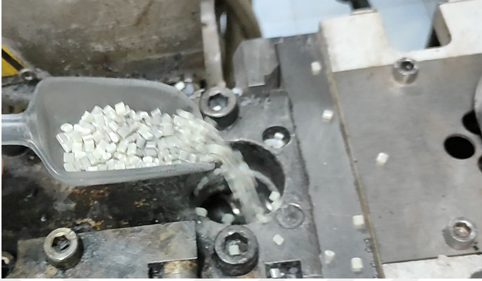
Şekil 4.4. ABS ve Demir tozu karışımının homojen bir karışım elde etmek için çift vidalı ekstrüzyon makinası eritme-karıştırma besleme oluğuna bırakılması
