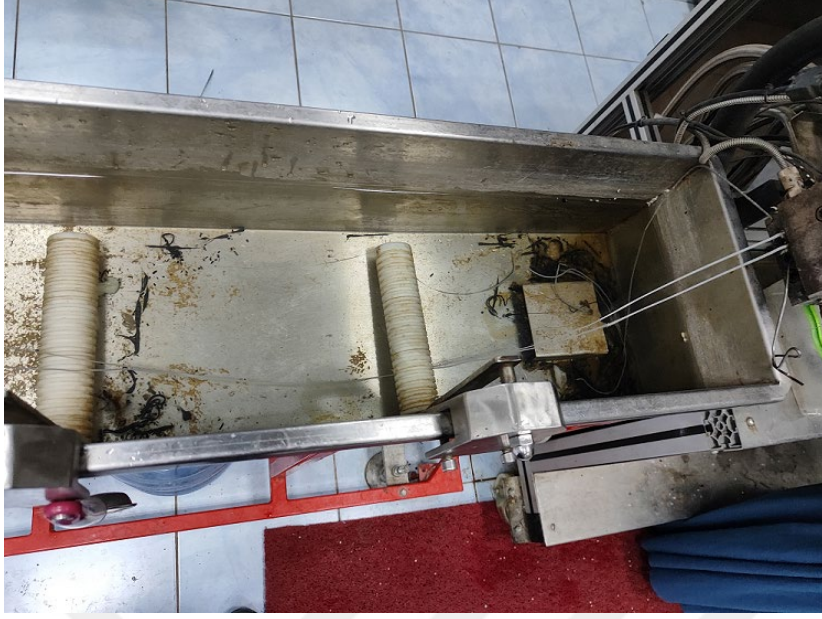
Şekil 4.6. Eriyik ABS ve Demir tozu karışımının şerit halde su dolu havuzda soğutulması
