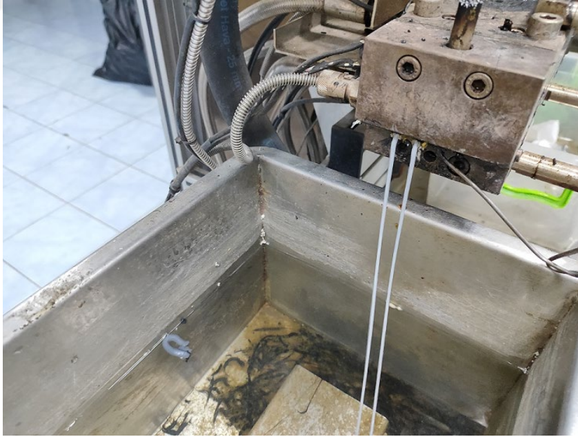
Şekil 4.5. ABS ve Demir tozu karışımının birbirine kaynamış ve homojen olarak çift vidalı ısıtıcı bölümünden soğutucu havuza çıkışı
