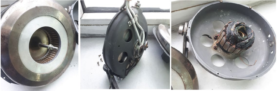
Şekil 2.7. Gemi cayro sistemlerinde kullanılan dış rotorlu 333 Hz asenkron motoru
