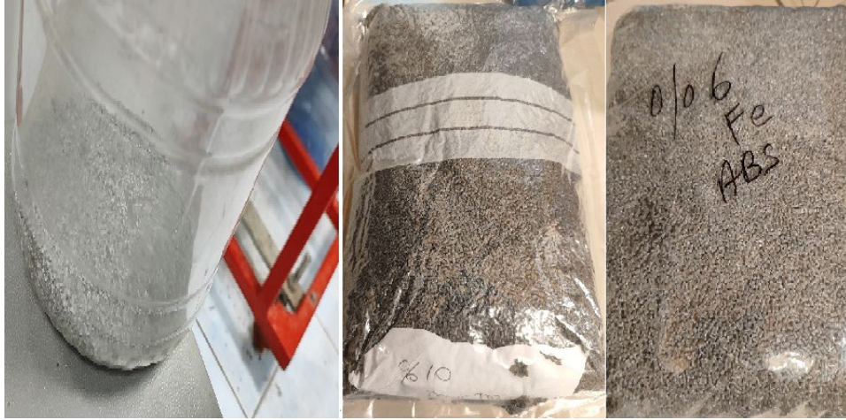
Şekil 4.9. %6-%10 oranlarda ayrı işlem ile üretilmiş granüller vakum poşetlerine alınarak nemden korunur
