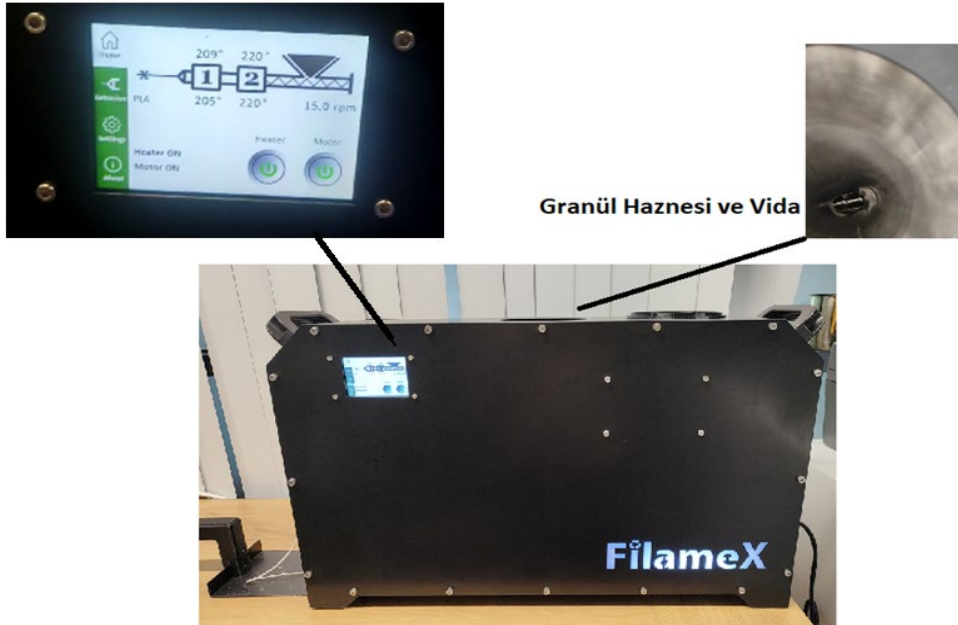
Şekil 4.11. Besleme kısmı kontrol paneli, haznesi ve vidası
