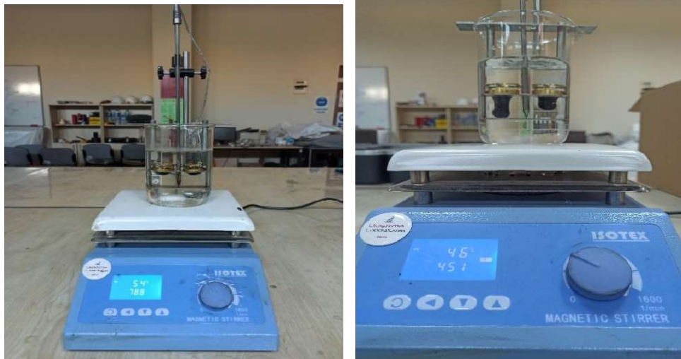
(a) Yumuşama noktası deneyi (b) Bitüm kaplı bilyelerin düşmesi
