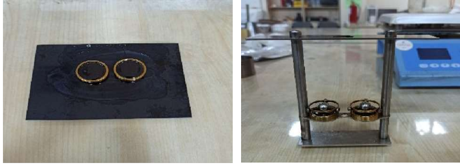
(a) Yumuşama noktası deney numunesi (b) Numunenin cihaza yerleştirilmesi Şekil 4.36. Yumuşama noktası deney numunesi ve numunenin cihaza yerleştirilmesi
