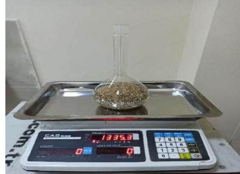
(b) İnce agregaya dolu piknometrenin tartımı
