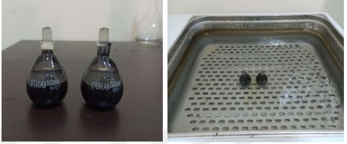
(a) Bitüm ve su doldurulmuş piknometreler (b) Su banyosunda bekletilen piknometreler Şekil 4.4. Bitüm ve su doldurulmuş piknometreler ve su banyosunda bekletilmesi
