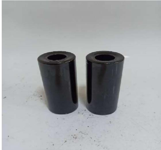
Şekil 4.46. RTFOT sonrası kütle kaybı hesabı için soğumaya bırakılan numuneler
