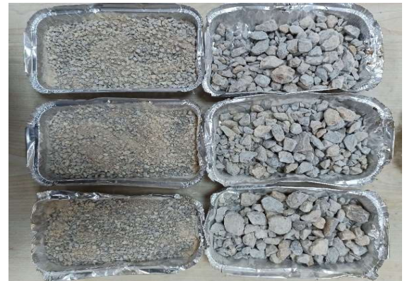
(b) Gradasyona uygun 1150 g agrega
