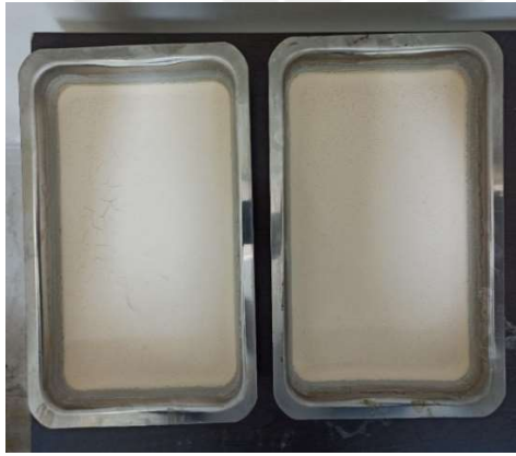
(a) Etüvde kurumuş filler numuneleri (b) Kurumuş filler numunesinin tartımı
