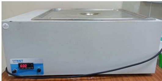
(a) 60°C sıcaklığa ayarlanmış su banyosu (b) Briketin su banyosunda bekletilmesi
