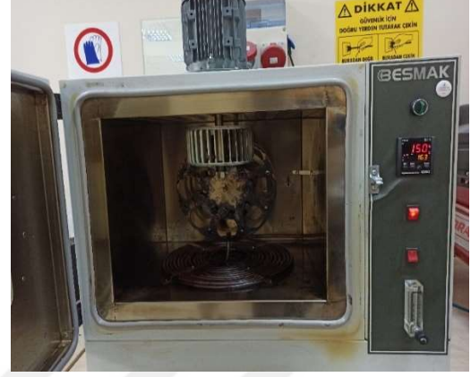
(b) RTFOT deney cihazının içi
