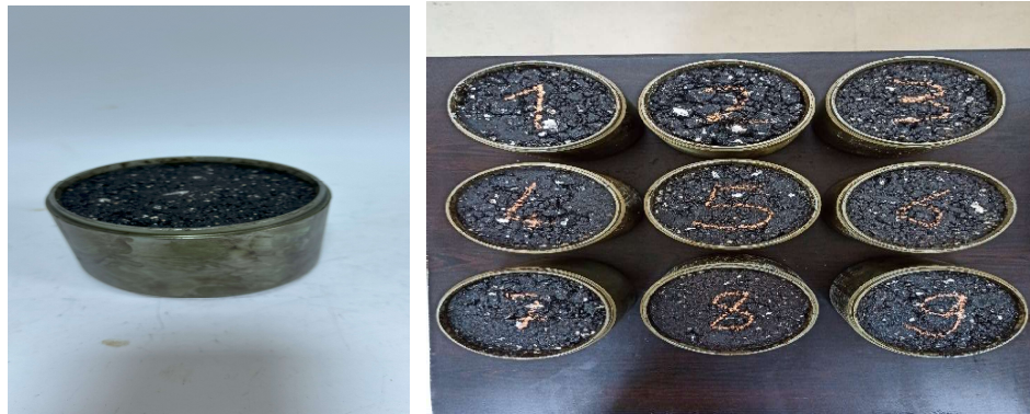
(a) Marshall kalıbı içindeki briket (b) Briketlerin soğumaya bırakılması
