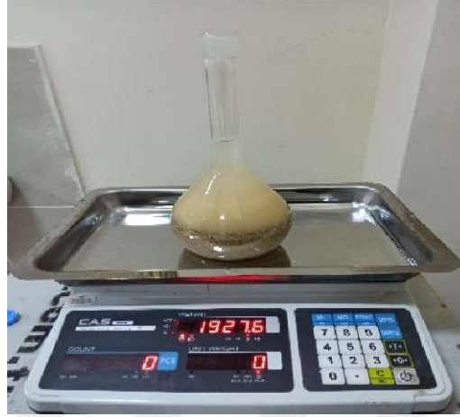
Şekil 4.16. Su ve ince agrega dolu piknometrenin tartımı
