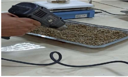
(a) Sıcak hava kaynağı ile kurutma
