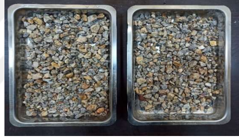
(b) Agregaların 24 saat su içinde bekletilmesi
