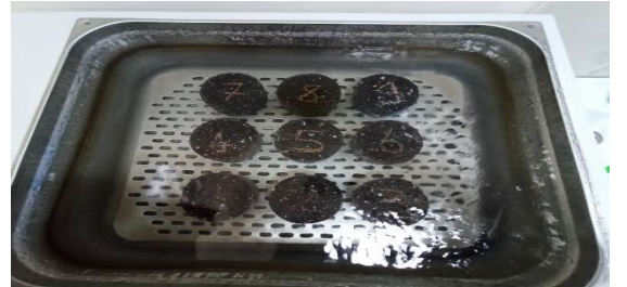
(a) 60°C sıcaklığa ayarlanmış su banyosu (b) Briketin su banyosunda bekletilmesi
