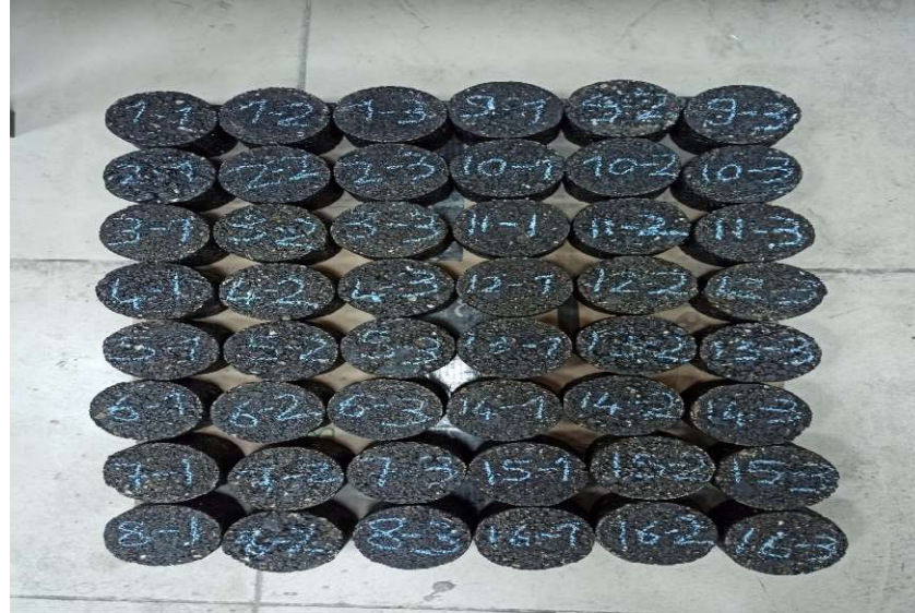
Şekil 4.58. 16 farklı karışımla hazırlanan 48 adet Marshall deney numunesi
