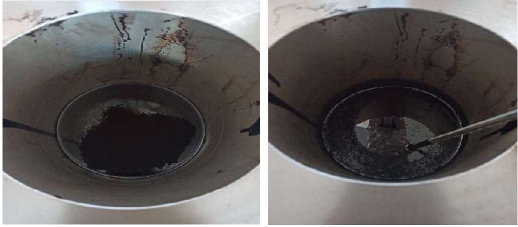
(a) GNP'nin mikserde bitüme eklenmesi (b) GNP'nin cam çubuk ile karıştırılması Şekil 4.30. GNP'nin mikserde bitüme eklenmesi ve cam çubuk ile karıştırılması
