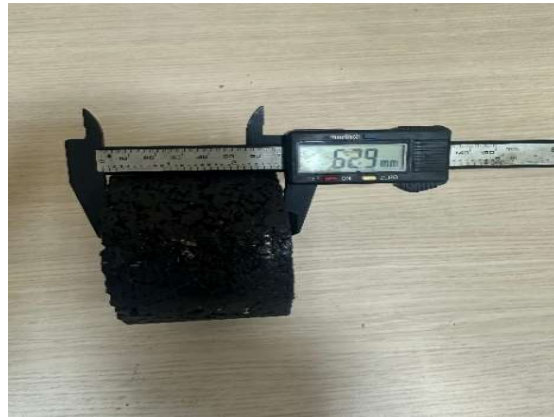
Şekil 4.53. Briketlerin yüksekliklerinin kumpas ile ölçülmesi
