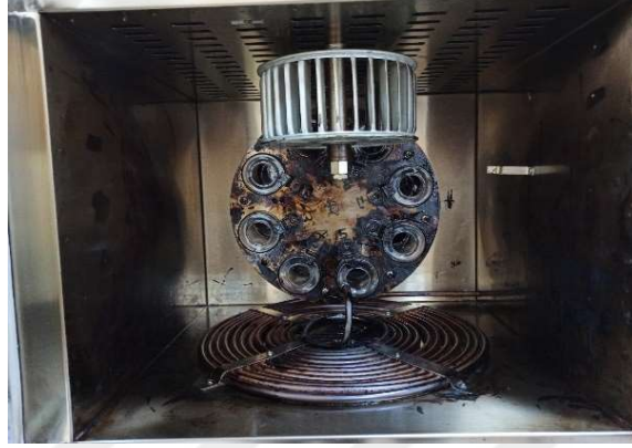
Şekil 4.45. 35 gram bitüm konulmuş RTFOT deney şişelerinin cihaza yerleştirilmesi
