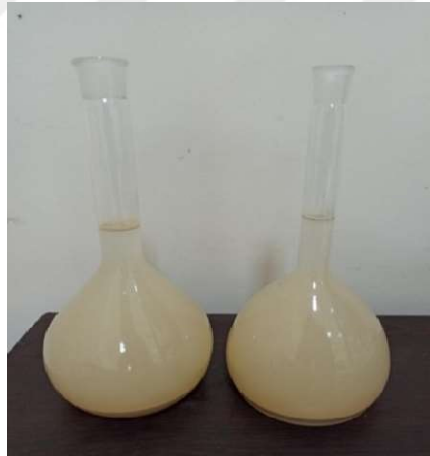
(a) Filler ve su dolu piknometreler (b) Filler ve su dolu piknometre tartımı
