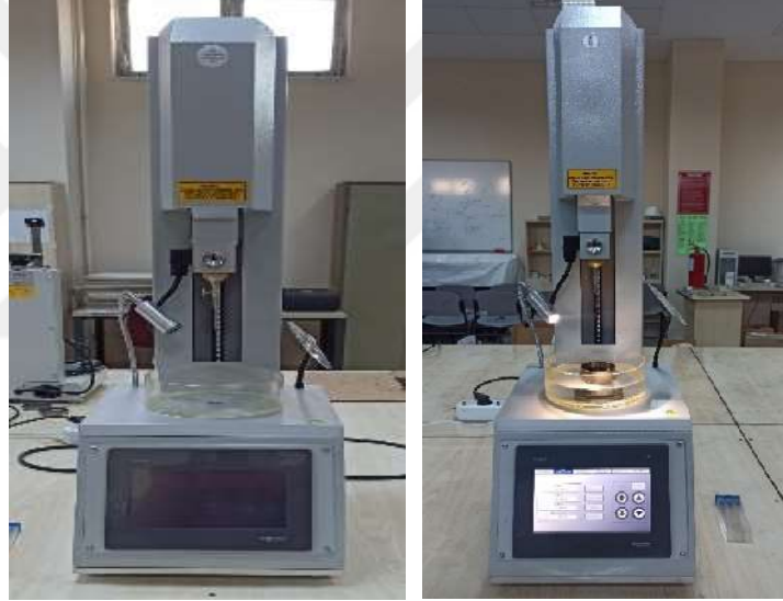
Şekil 4.33. Kapalı ve açık durumdaki penetrasyon deney cihazı
