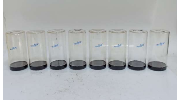
(b) 35 g bitüm konulmuş RTFOT deney şişeleri
