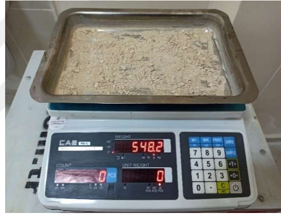
(a) Etüvde kurumuş filler numuneleri (b) Kurumuş filler numunesinin tartımı
