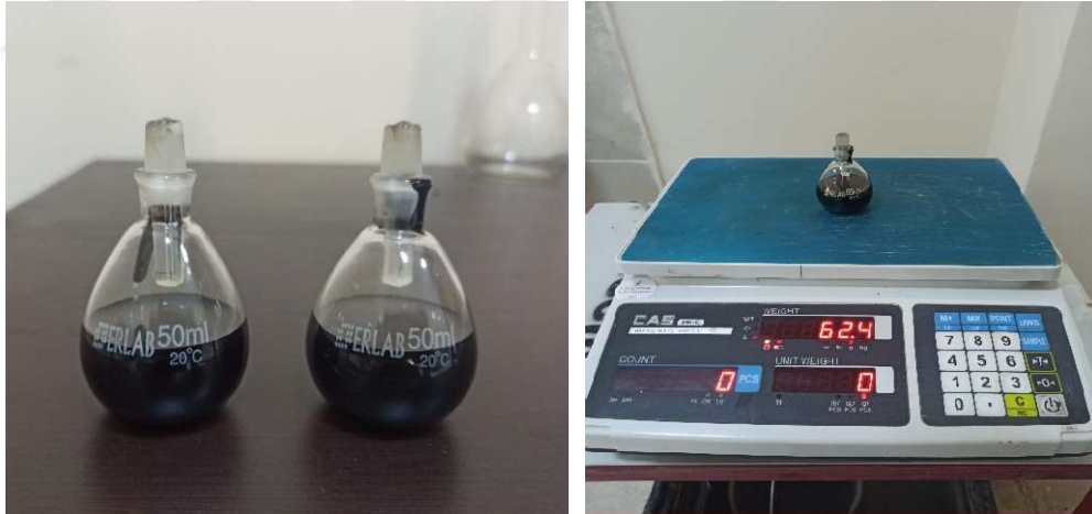
(a) Bitüm doldurulmuş piknometreler (b) Bitüm dolu piknometrenin tartımı Şekil 4.3. Bitüm doldurulmuş piknometreler ve bitüm dolu piknometrenin tartımı
