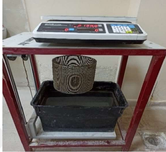
Şekil 4.10. Agregaların sudaki ağırlığının tartılması
