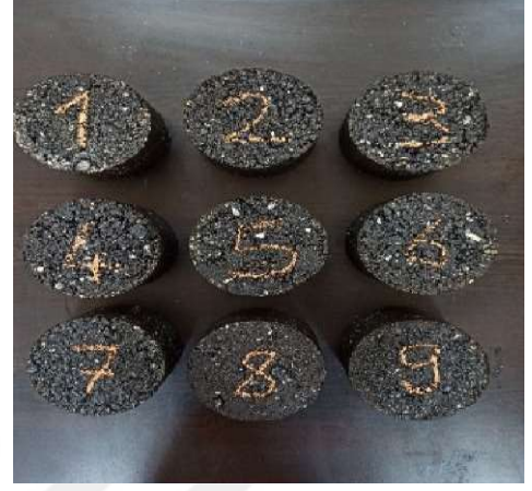
(a) Briketlerin kriko ile kalıptan çıkarılması (b) Kalıptan çıkarılmış briketler
