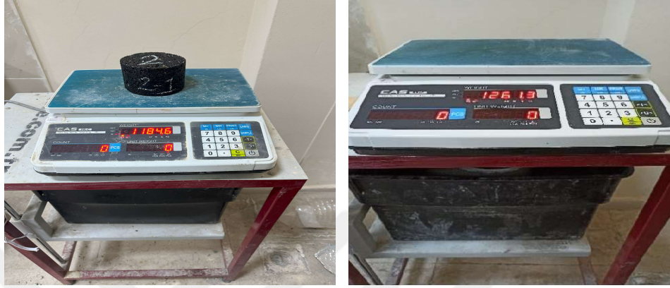
(a) Briket havadaki ağırlığının tartılması (b) Briket sudaki ağırlığının tartılması
