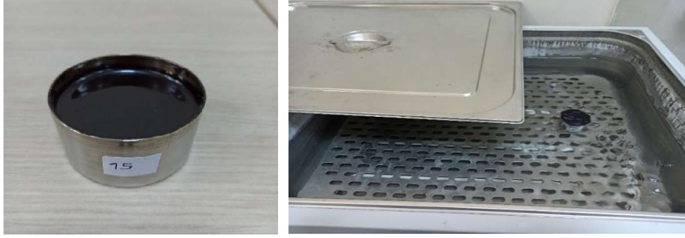
(a) Penetrasyon deney numunesi (b) Numunenin su banyosunda bekletilmesi
