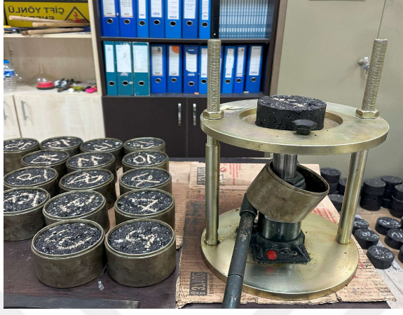
(a) Briketlerin kriko ile kalıptan çıkarılması (b) Kalıptan çıkarılmış briketler
