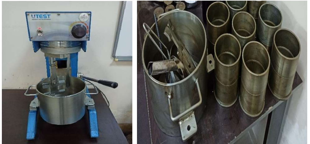
(a) Karıştırma için kullanılan mikser (b) Marshall deney kalıpları
