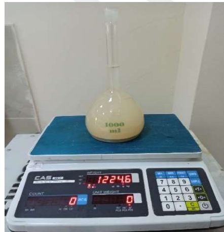
(a) Filler ve su dolu piknometreler (b) Filler ve su dolu piknometre tartımı
