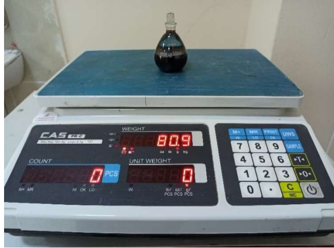
Şekil 4.5. Bitüm ve su doldurulmuş piknometrelerin su banyosundan sonra tartılması
