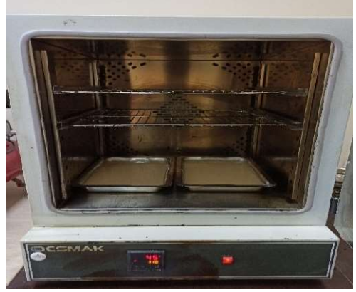
(a) Numunelerin tepsiye boşaltılması (b) Numunelerin etüvde kurutulması
