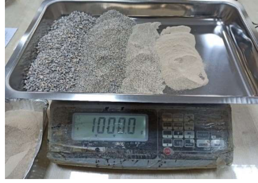
(a) Gradasyona uygun ince agrega tartılması (b) Uygun oranlarda tartılan ince agregalar
