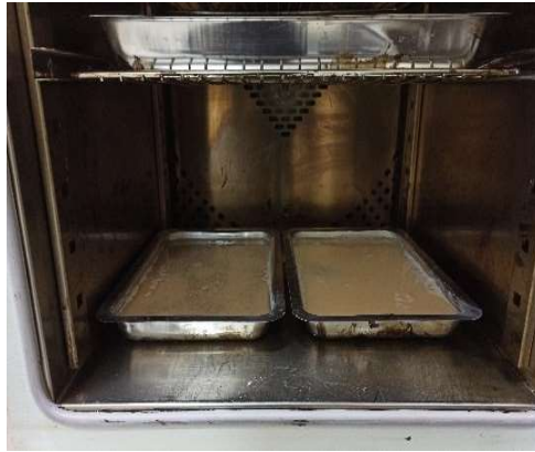
(a) İnce agreganın etüvde kurutulması (b) Kurumuş ince agreganın tartımı
