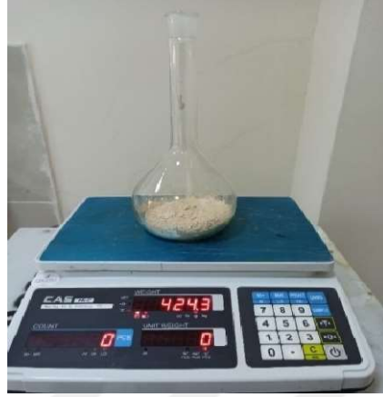
Şekil 4.21. Filler dolu piknometre tartımı
