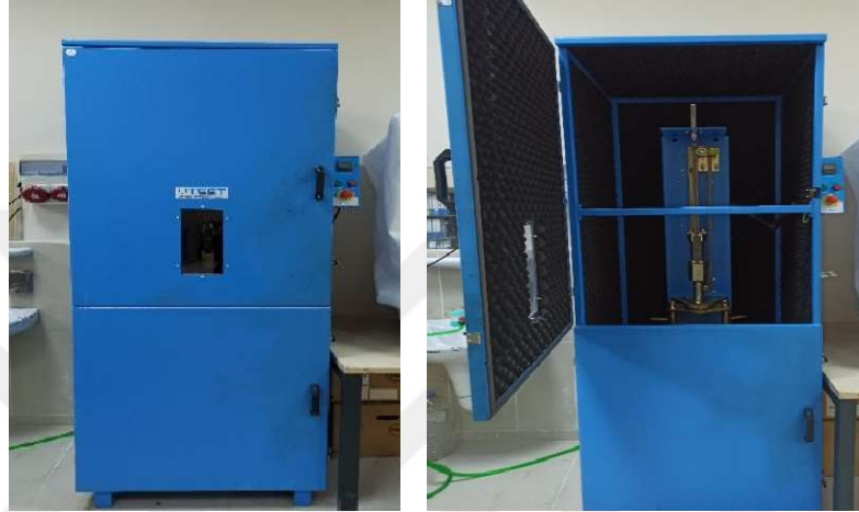
(a) Tokmak cihazı (b) Tokmak cihazına numune yerleştirilmesi
