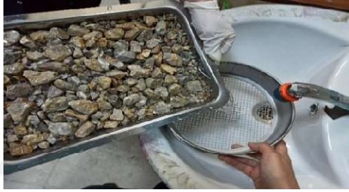
(a) Agregaların yıkanması
