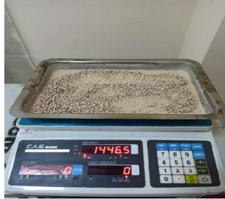
(a) İnce agreganın etüvde kurutulması (b) Kurumuş ince agreganın tartımı
