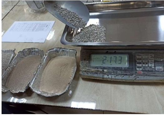
(a) Gradasyona uygun ince agrega tartılması (b) Uygun oranlarda tartılan ince agregalar
