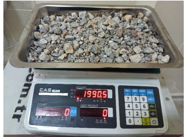
(b) Etüvde kurutulmuş agregaların tartımı
