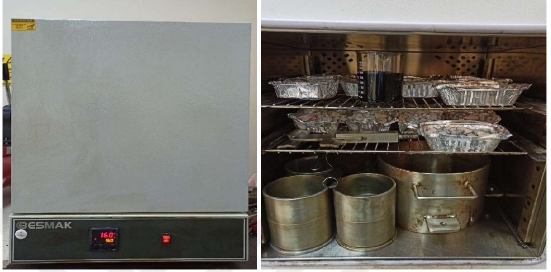
(a) 160°C sıcaklıktaki etüv (b) Marshall deney malzemelerinin etüvde ısıtılması
