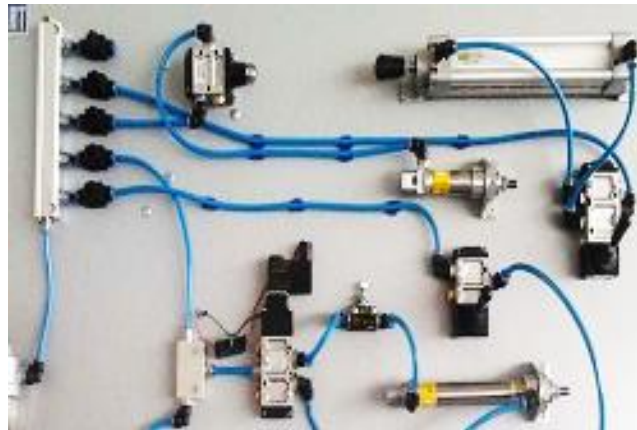
Şekil 2.13: Elektropnömatik Devre Uygulaması Örneği
