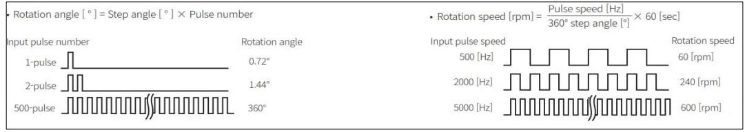
Şekil 3.16. Step Motorun Açık ve Açısal Hız Karakteristik Sinyalleri
