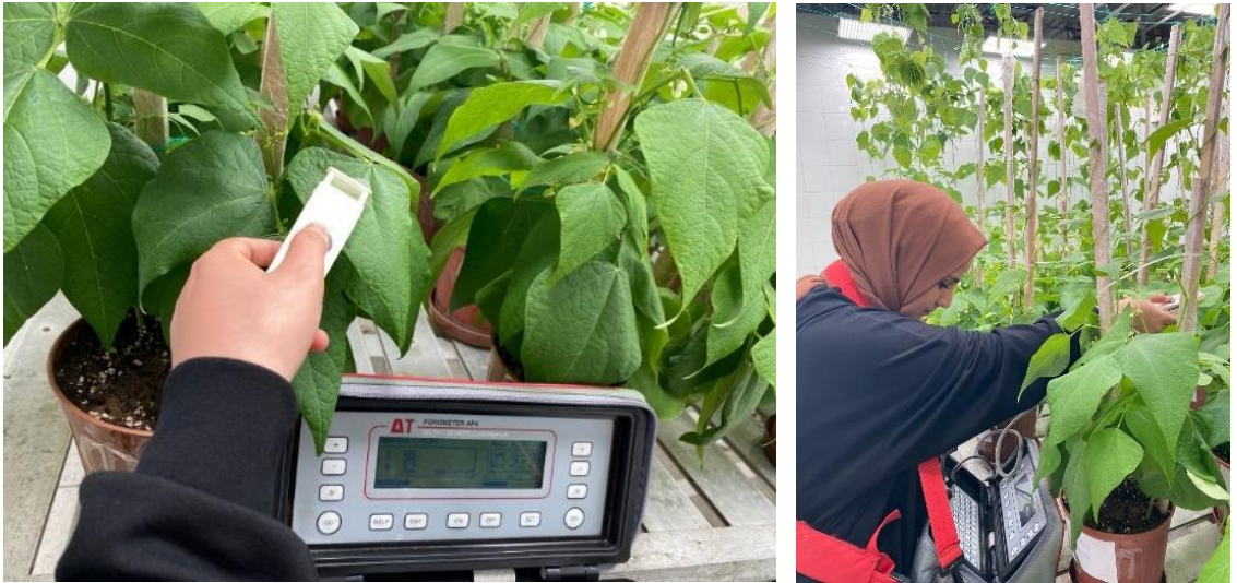
Şekil 3.12. Yaprak stoma iletkenliğinin porometre cihazı ile ölçülmesi.
