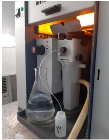
Şekil 3.13. Mineral element analizleri yapımından ve atomik absorpsiyon cihazından görseller.
