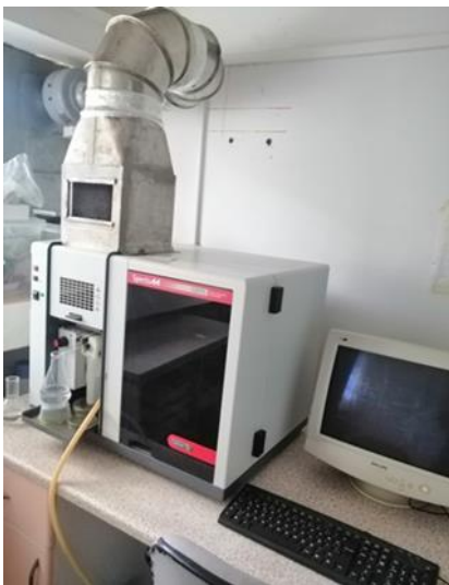
Şekil 3.13. Mineral element analizleri yapımından ve atomik absorpsiyon cihazından görseller.
