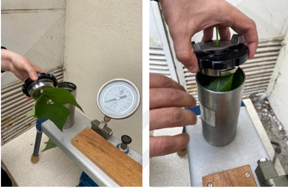
Şekil 3.11. Yaprak su potansiyelinin basınç çemberi ile ölçülmesi.
