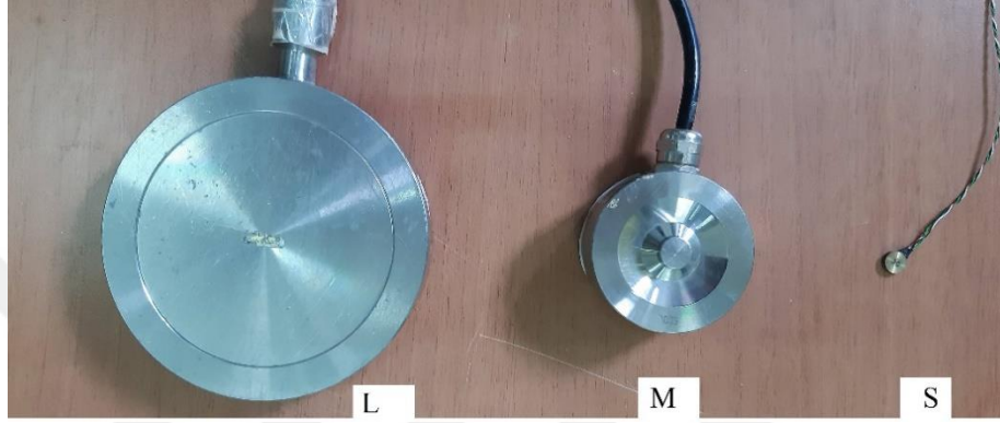
Şekil 3. 5 Gerilme ölçümleri için kullanılan farklı boyutlardaki loadceller
