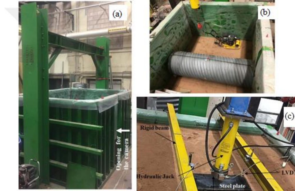
Şekil 1. 22 Deneylere ait detaylar a) model deney sistemi b) deney kurulum aşaması c) bölgesel yükleme plakası (Mahgoud ve El Naggar, 2020)
