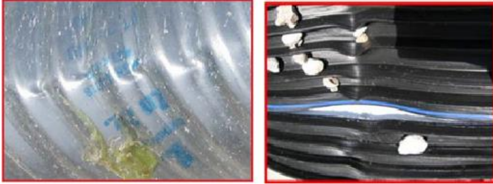
Şekil 7.5 Yatay simetri eksenindeki yapısal hasarlar
