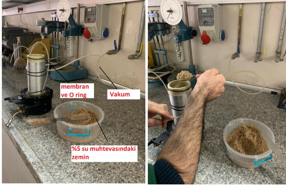
Şekil 2. 15 Üç eksenli numuneler için numune hazırlanması
