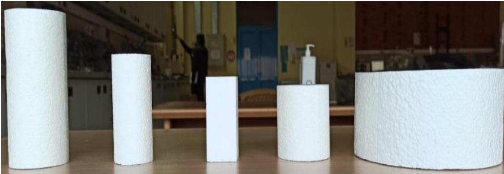
Şekil 2. 19 Farklı boy/çap oranları ve farklı yoğunluktaki EPS numuneler
