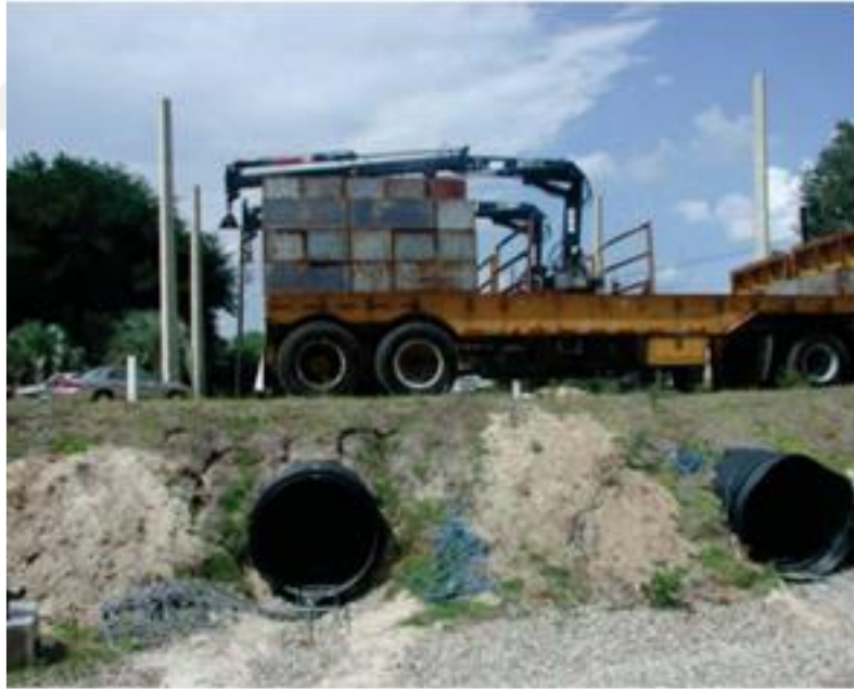
Şekil 1.8 Arazi koşullarında sığ gömülü esnek boru için yükleme koşulları (Chaallal vd., 2015)
