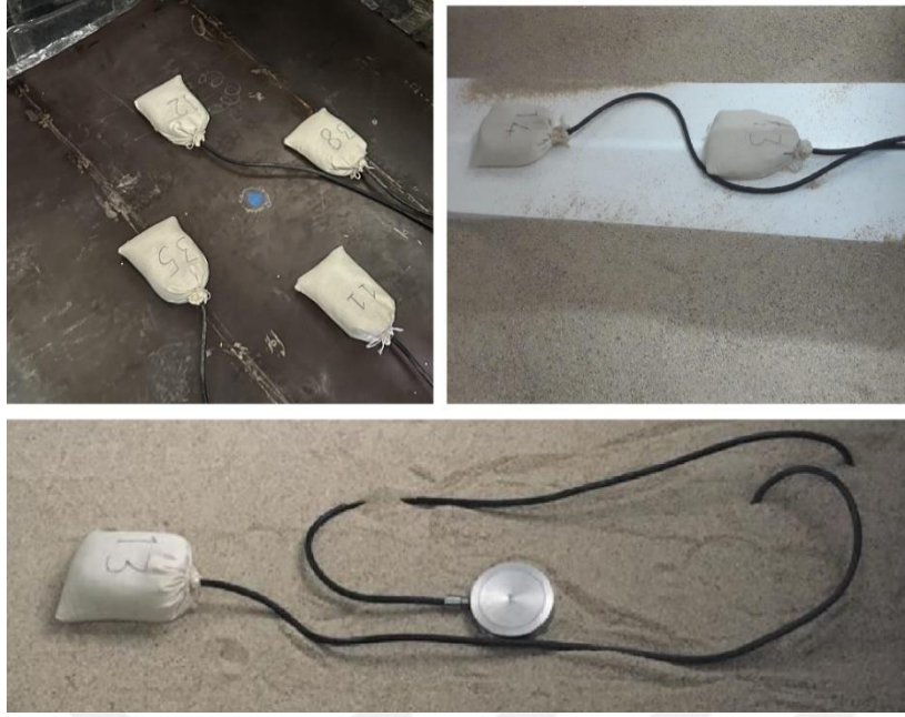
Şekil 3. 13 Gerilme ölçerlerin daha efektif çalışması için başlık uygulaması
