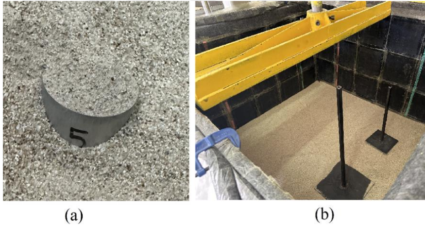
Şekil 3. 11 Kumun kontrollü sıkıştırılması a) \gamma_k kontrolü b) sıkıştırma plakaları ve tank duvarlarının ölçeklendirilmesi
