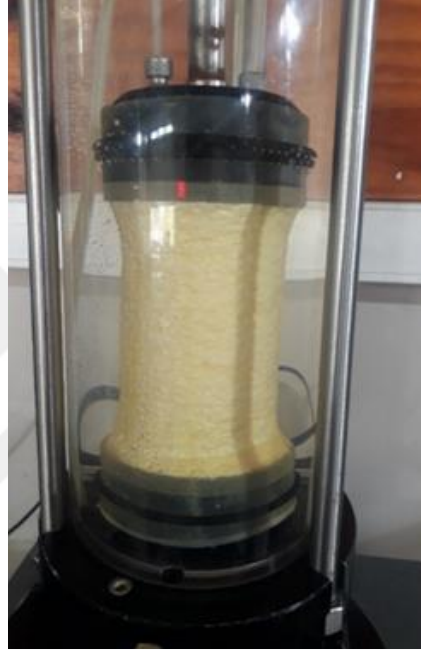
Şekil 2. 24 Hücre basınçlarına bağlı olarak EPS Geofoamdaki hacim değişimleri
