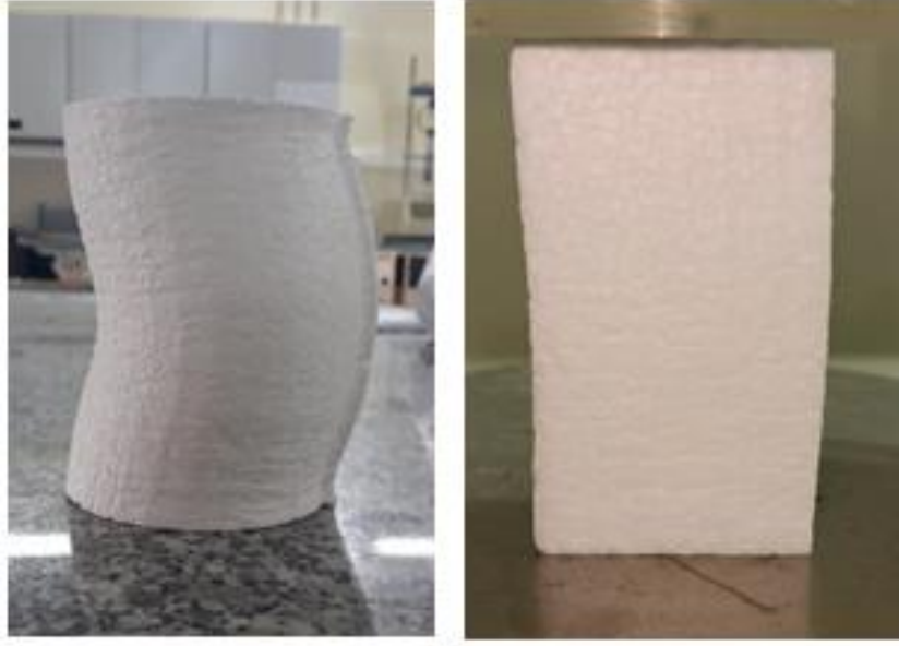
Şekil 2. 22 Serbest basınç deneylerinde EPS Geofoamdaki eğilme davranışı
