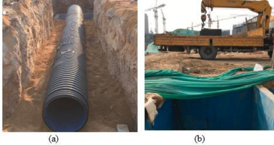
Şekil 1. 7 Arazi deneyleri için detaylar a) kurulum aşaması b) yükleme aşaması (Fang vd., 2019)
