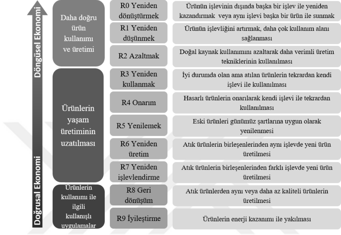
Şekil 3.3: Döngüsellikte 9R kavramı. Krichher ve diğ.’den (2017) uyarlanmıştır.
