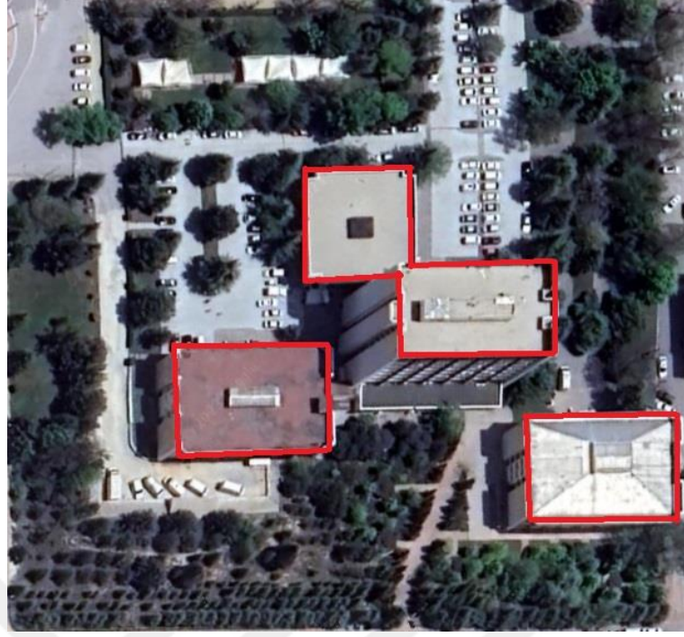
Şekil 4.4. Yağmur suyu hasat edilecek çatı alanları
