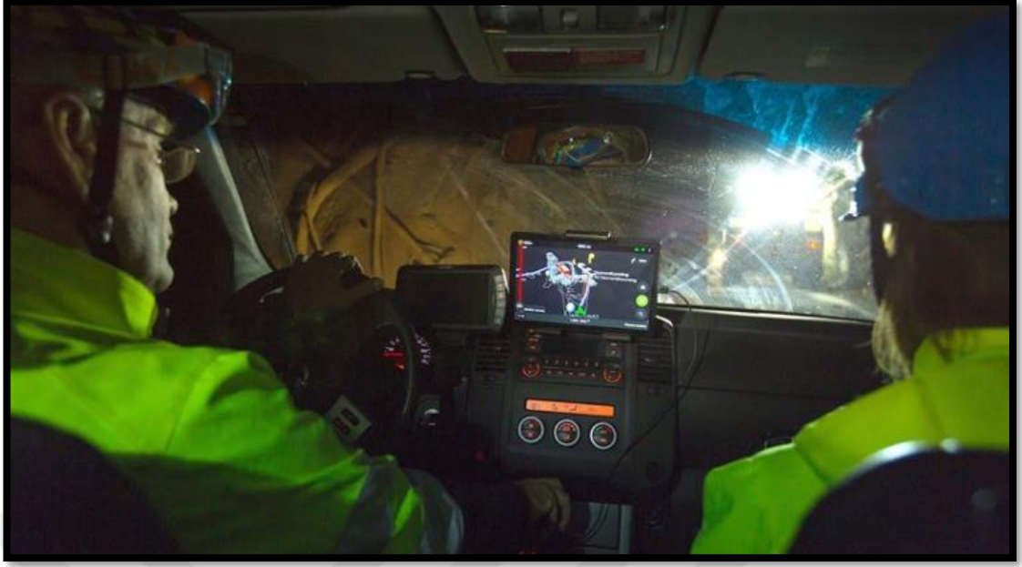
Şekil 2.5 Anlık olarak konumlama ve mekânsal analiz yapmaya yarayan Mobilaris sistemi (Mobilaris, 2014)
