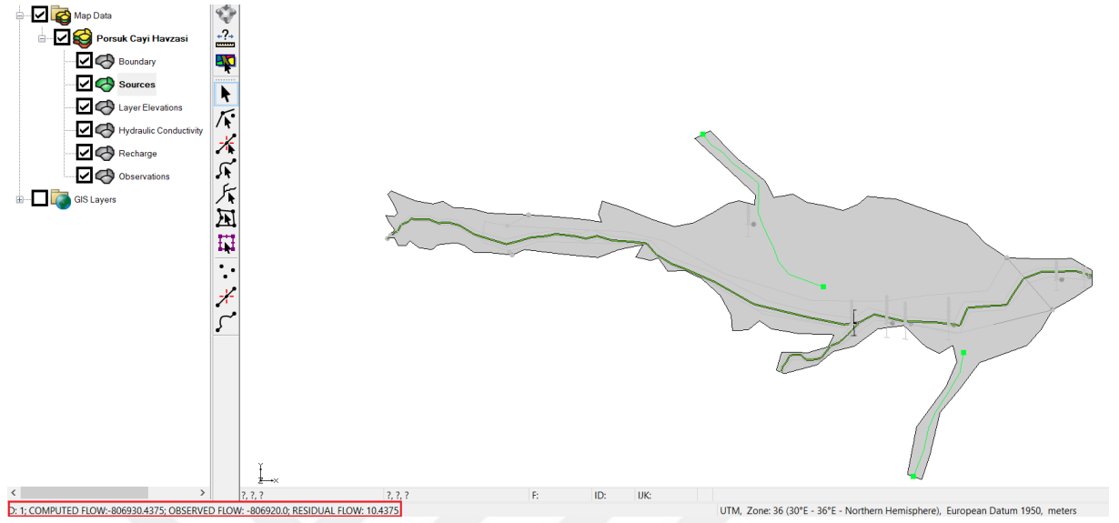
Şekil 4.11. Akışın hesaplanan (computed) ve gözlenen (observed) değerleri
